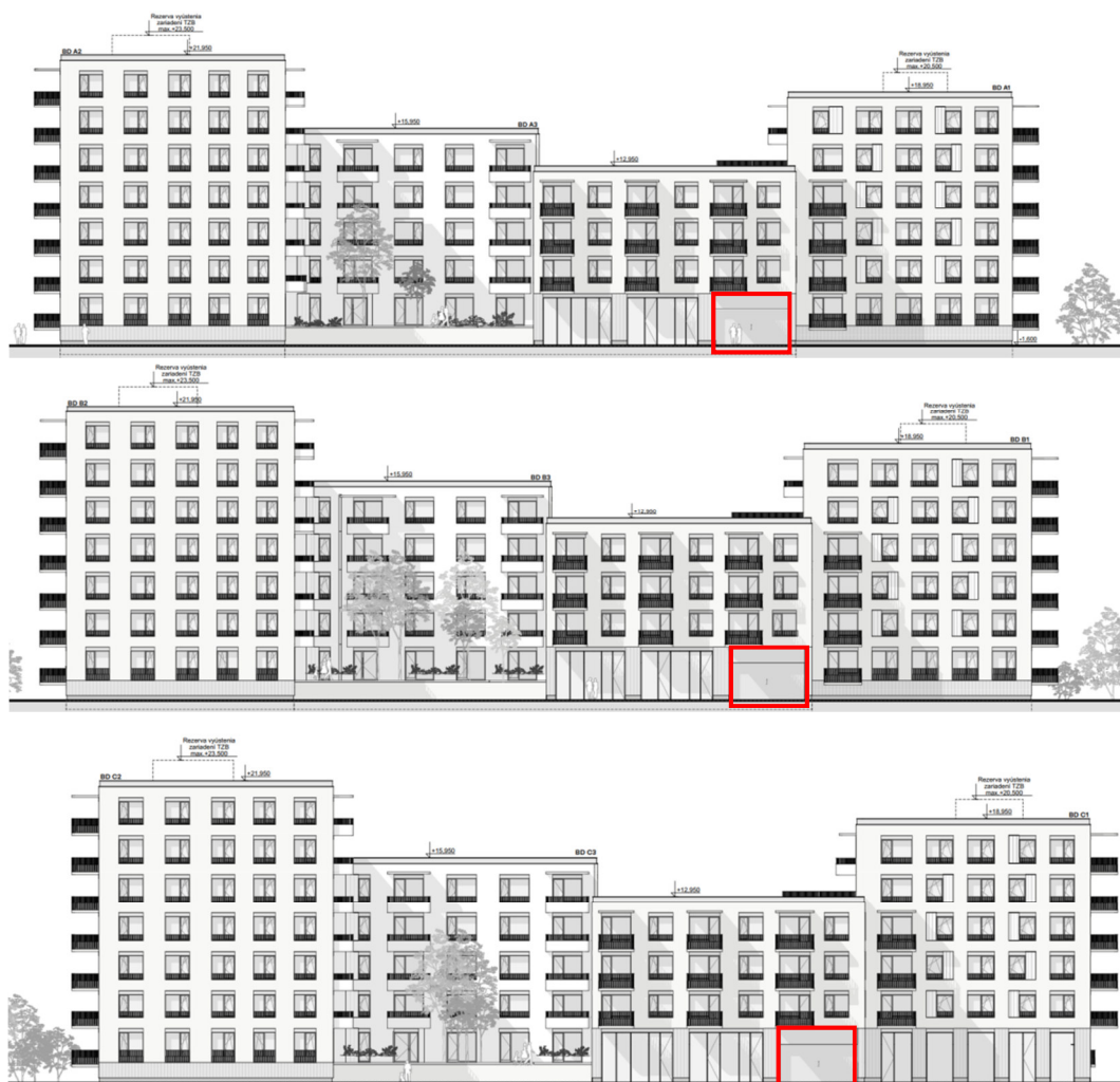
Obr. 9 Južné pohľady na bloky A, B a C a vyznačené vjazdy do podzemných garáží
