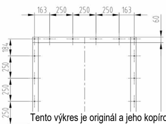
Flansch Einlaufftirwand Trockentrommel
