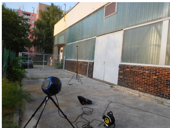
Obr. 3 Meranie rozdielu hladín na západnej fasáde
