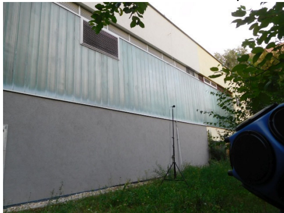
Obr. 5 Meranie rozdielu hladín na východnej fasáde
