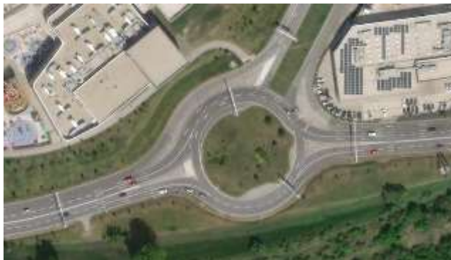
existujúca turbo-okružná križovatka
