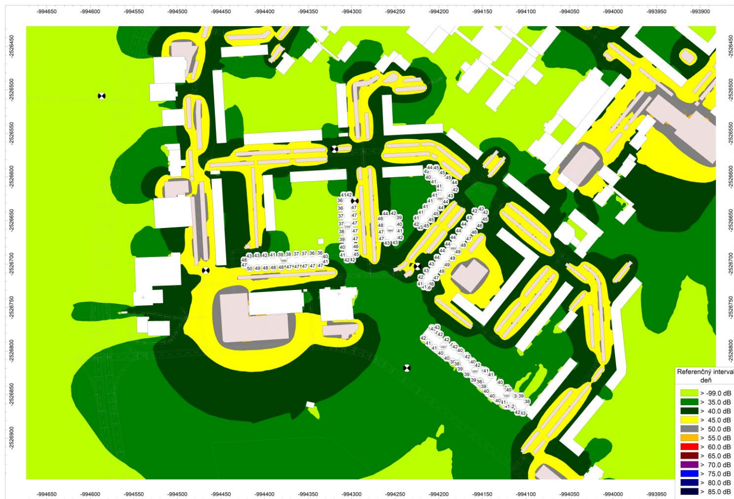
Príloha 7.7: Hluková mapa vplyvu hluku z iných zdrojov na okolité obytné prostredie v súčasnom stave – ref. interval deň (zobrazené je L_{Aeq,d} pre výšku 1,5 m nad terénom)
