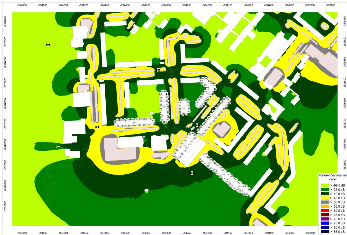
Príloha 7.11: Hluková mapa vplyvu hluku z iných zdrojov na okolité obytné prostredie v budúcom stave – ref. interval večer (zobrazené je L_{Aeq,v} pre výšku 1,5 m nad terénom)
