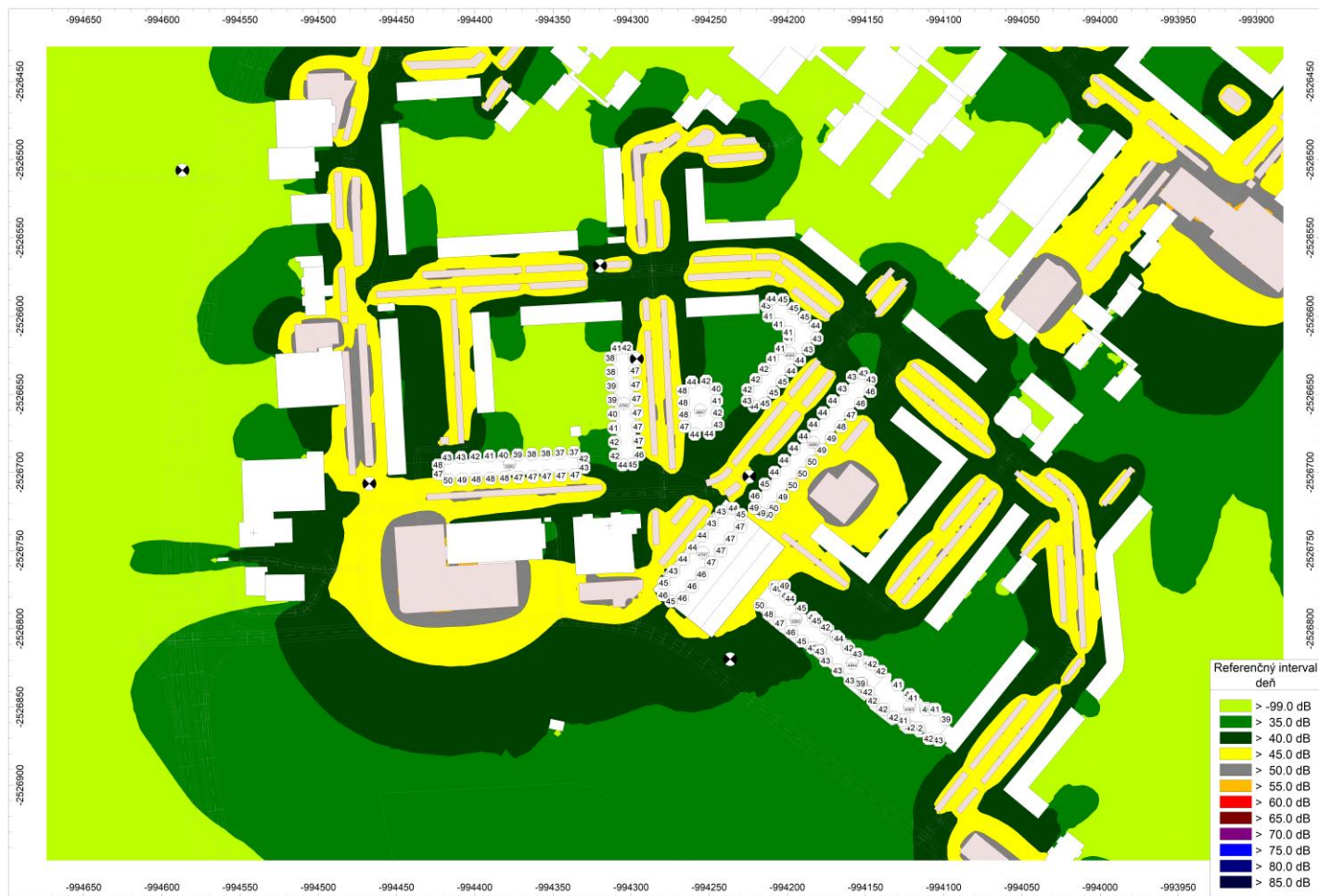
Príloha 7.10: Hluková mapa vplyvu hluku z iných zdrojov na okolité obytné prostredie v budúcom stave – ref. interval deň (zobrazené je L_{Aeq,d} pre výšku 1,5 m nad terénom)
