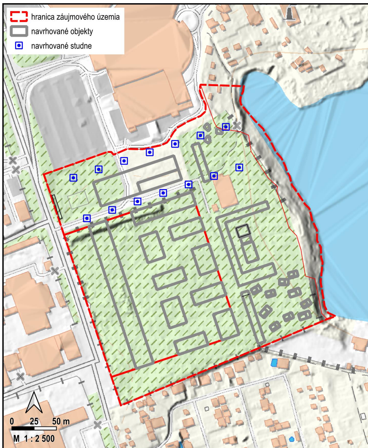
Obr. 8 : Návrh lokalizácie zdrojov podzemných vôd (hydrogeologické vrtý – studne) pre energetické účely.
