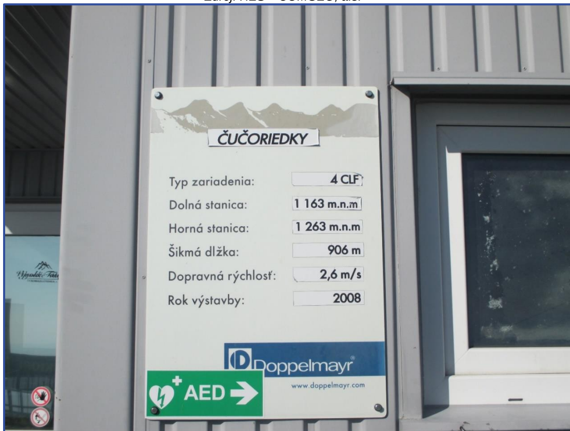
Obrázok 5: Údolná stanica 4-CLF Čučoriedky – variant 0 – technicko-prevádzkové údaje Zdroj: HES – COMGEO, a.s.
