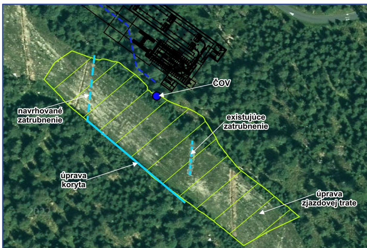
Obrázok 19: Navrhovaná úprava zjazdovej trate a koryta potoka
