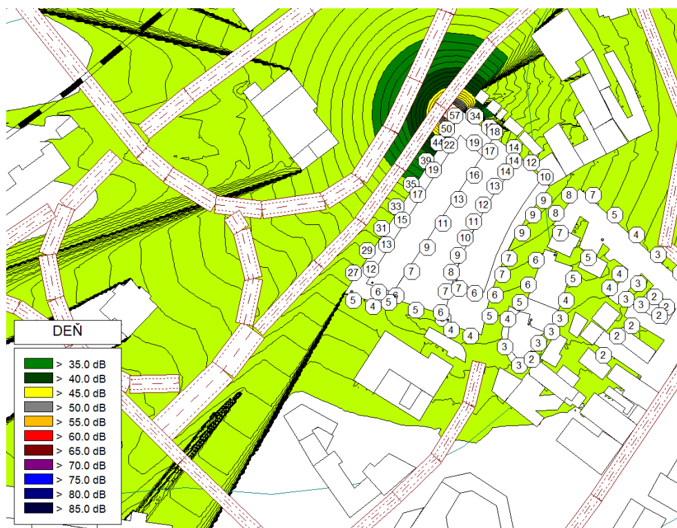
Obrázok 18 Plošná hluková záťaž spôsobená statickou dopravou vypočítaná vo výške 1,5 m nad terénom a najvyššie vypočítané hodnoty L_{Aeq} 2 m pred fasádou posudzovaného polyfunkčného objektu a fasádami okolitých budov, pre referenčný časový interval DEŇ
