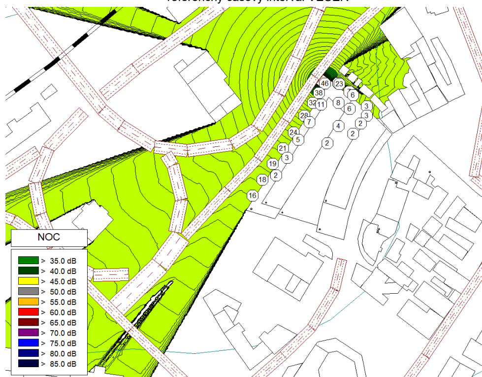
Obrázok 20 Plošná hluková záťaž spôsobená statickou dopravou vypočítaná vo výške 1,5 m nad terénom a najvyššie vypočítané hodnoty L_{Aeq} 2 m pred fasádou posudzovaného polyfunkčného objektu a fasádami okolitých budov, pre referenčný časový interval NOC
