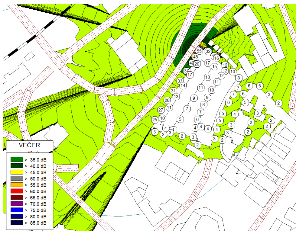
Obrázok 19 Plošná hluková záťaž spôsobená statickou dopravou vypočítaná vo výške 1,5 m nad terénom a najvyššie vypočítané hodnoty L_{Aeq} 2 m pred fasádou posudzovaného polyfunkčného objektu a fasádami okolitých budov, pre referenčný časový interval VEČER
