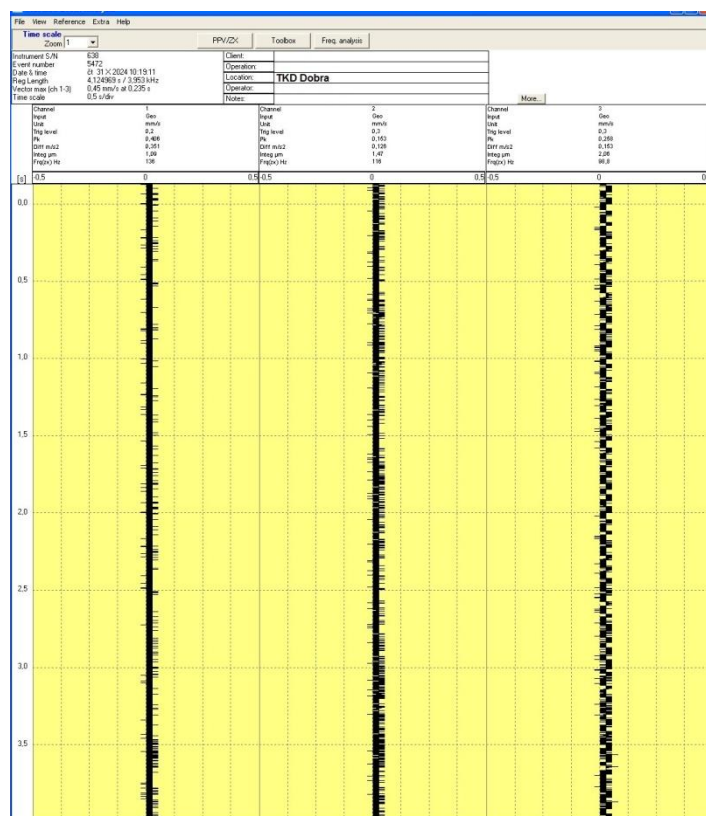
3.2.4 Grafický záznam priebehu jednotlivých zložiek seizmického vlnenia na meracom stanovisku V1 zo dňa 31. októbra 2024 nameraných pri koľaji pri pohybe mostového žeriavu smerom ku stanovisku S1.
