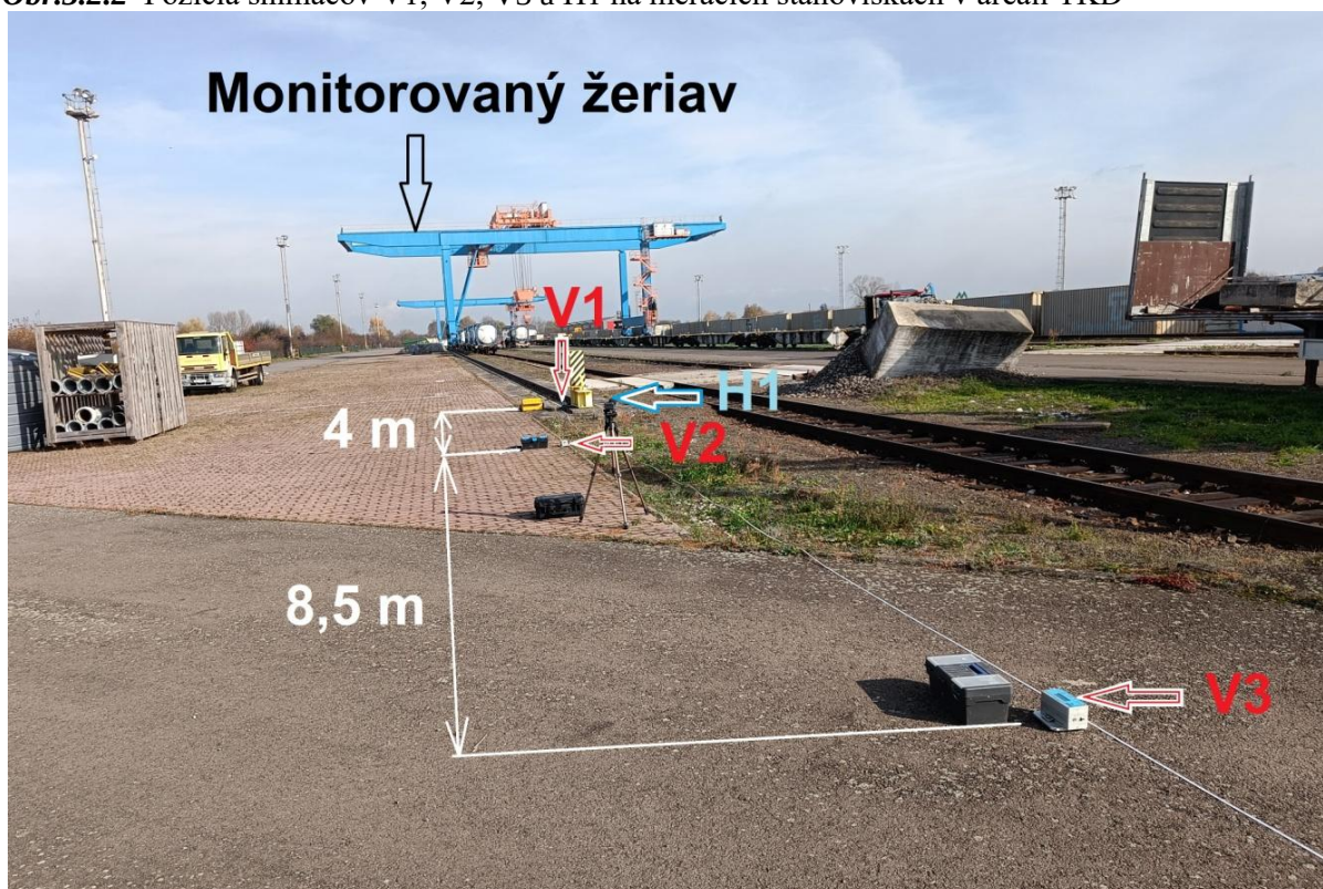
Obr.3.2.2 Pozícia snímačov V1, V2, V3 a H1 na meracích stanoviskách v areáli TKD
