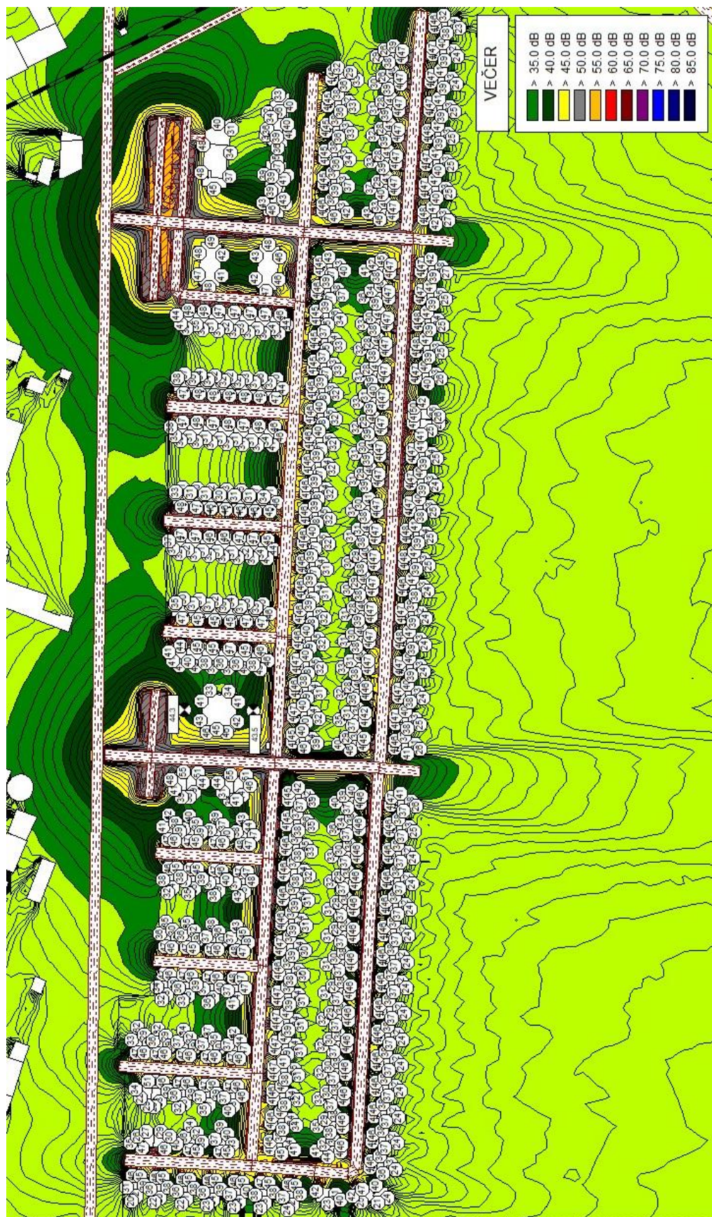
Obrázok 12 Plošná hluková záťaž spôsobená statickou dopravou vypočítaná vo výške 1,5 m nad terénom a najvyššie vypočítané hodnoty ekvivalentnej hladiny A zvuku L_{Aeq} 2 m pred fasádou posudzovaných rodinných domov, bytových domov a materskej školy pre referenčný časový interval VEČER
