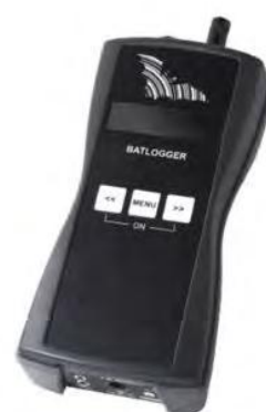
Obr. 2 Ultrazvukové detektory použité na statické (automatické) nahrávanie – Song Meter Mini Bat a na aktívne (bodové transekty) nahrávanie – Batlogger M.
