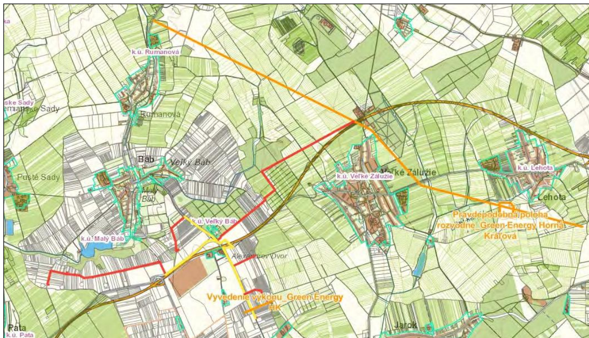
Obrázok 2: Navrhované vedenie prístupových komunikácií počas výstavby a prevádzky, elektrického vedenia a miesta vyvedenia elektrického výkonu*
