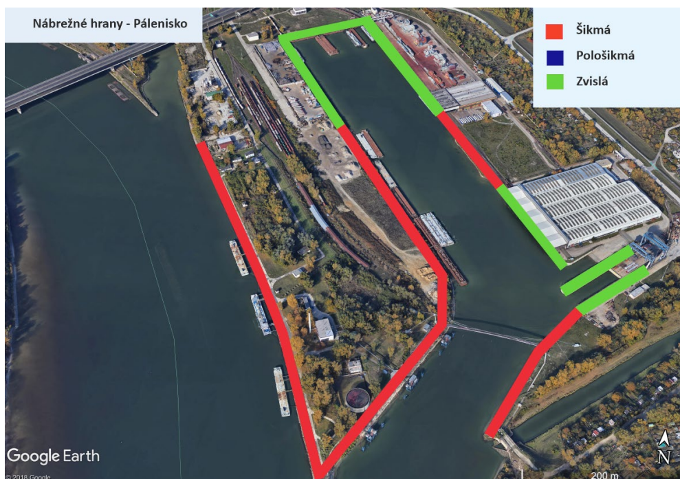
Obrázok 12: Typové riešenie nábrežnej hrany v časti Pálenisko
