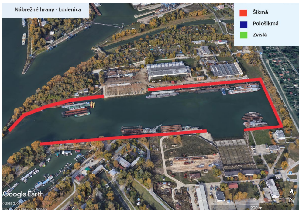
Obrázok 14: Typové riešenie nábrežnej hrany v bazéne Lodenica
