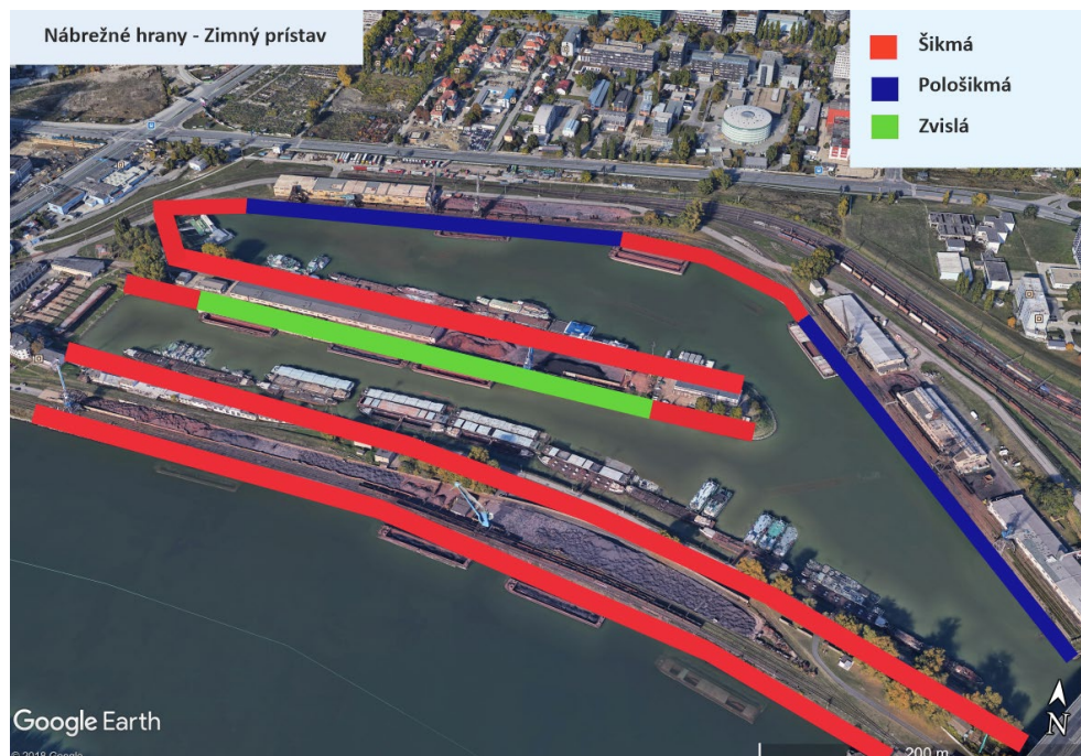
Obrázok 10: Typové riešenie nábrežnej hrany v zimnom prístave
