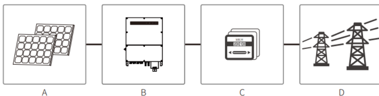
Položka: A – fotovoltaický panel (monokryštalický, polykryštalický, i.), B – Meniče (typ MT), C – Rozvodná skriňa, D – Úžitková sieť (TN-S, TN-C, TN-C-S, TT, IT, rôzne typy modelov s rôznymi typmi rozvodnej siete)
