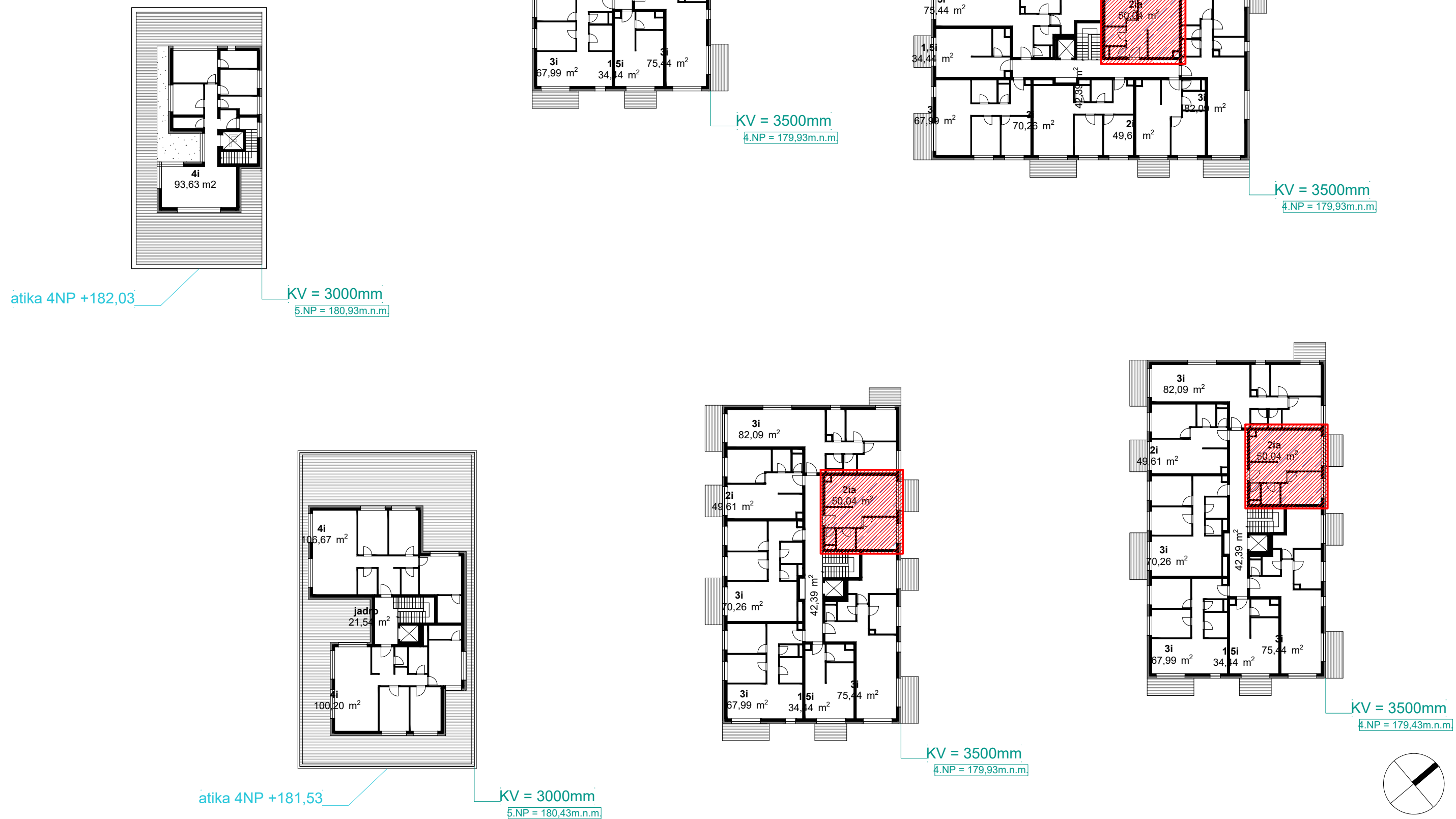
Obr. 14 Pôdorys úrovne 179,43 - 180,93 mm a hodnoty preslnenia posudzovaných kontrolných bodov
