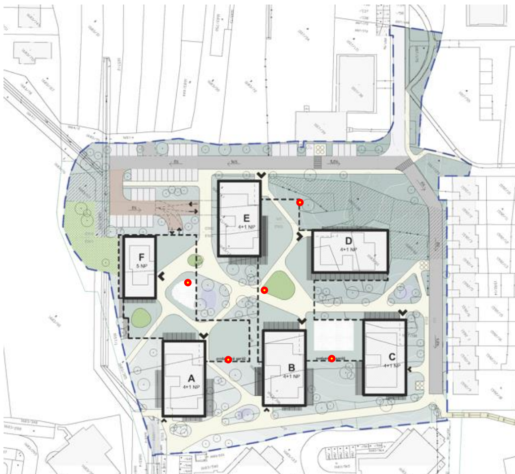
Obrázok 11: Umiestnenie odvodu VZT z podzemnej garáže
