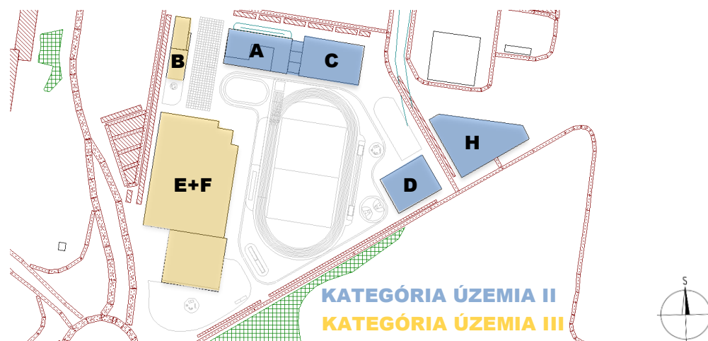
Obrázok 24 Situácia územia v akustickom programe CadnaA, s rozdelením objektov do kategórií chráneného územia
