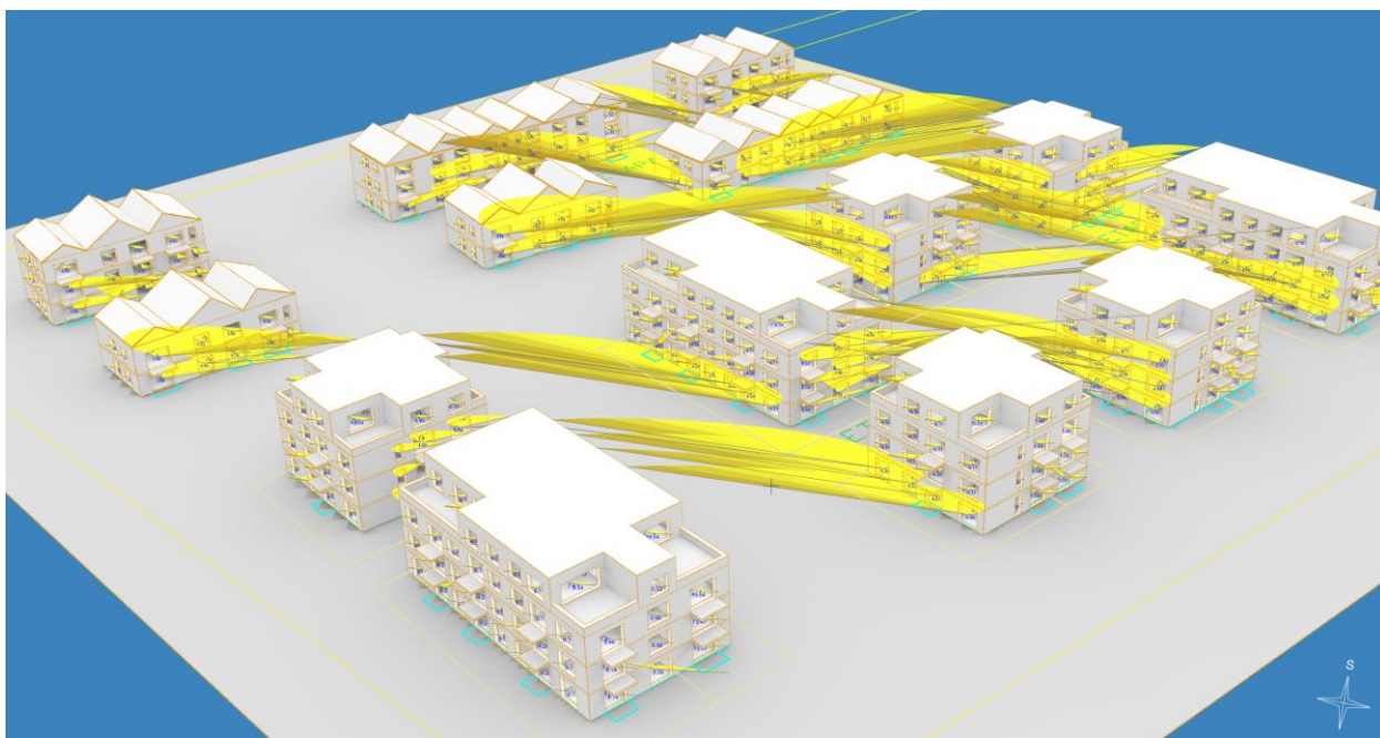
Obr. 13 3D model posudzovaného objektu a lokality s vyznačením priebehov preslnenia
