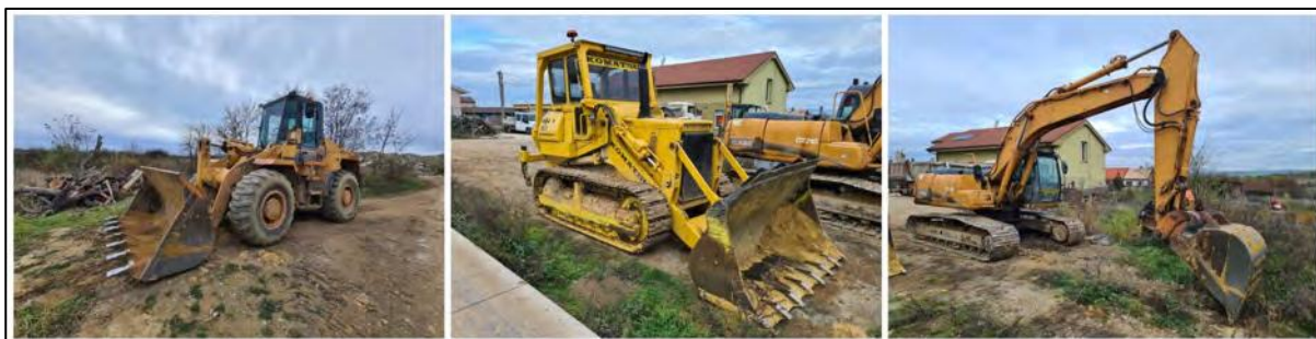
Obrázok 6: Technika, ktorá bude využívaná pri realizácii navrhovanej činnosti – hydraulický nakladač CASE, buldozér KOMATSU, pásové rýpadlo CASE (platí pre oba varianty)
