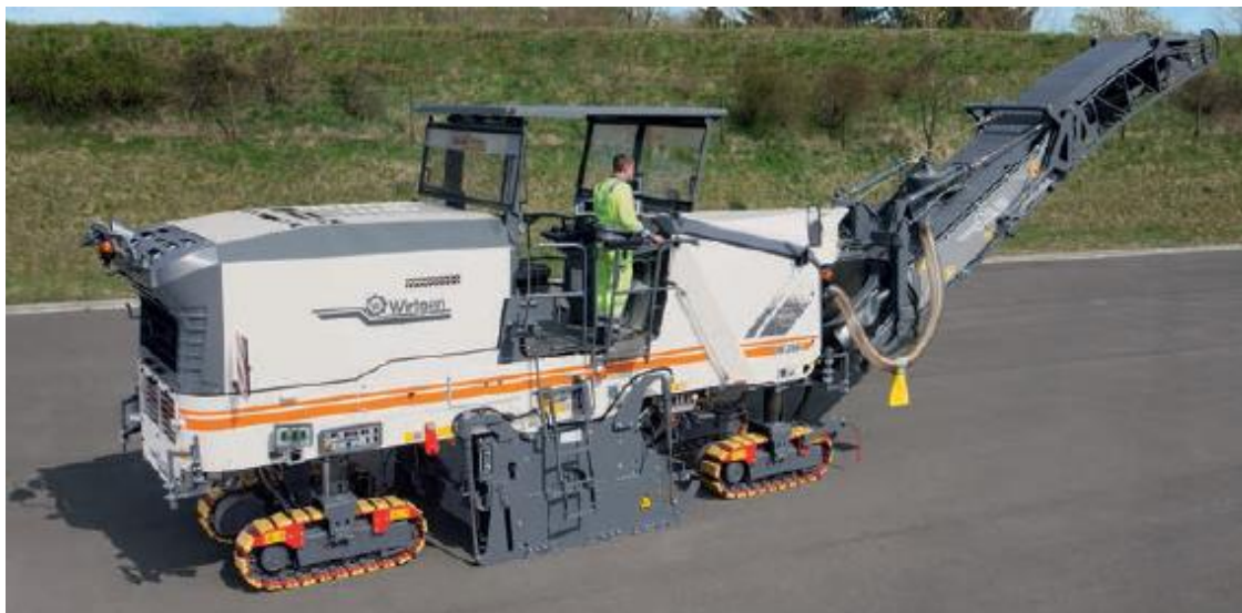
Obr. 3 Mobilné zariadenie (cestná fréza) na zhodnocovanie stavebného odpadu typu Wirtgen
