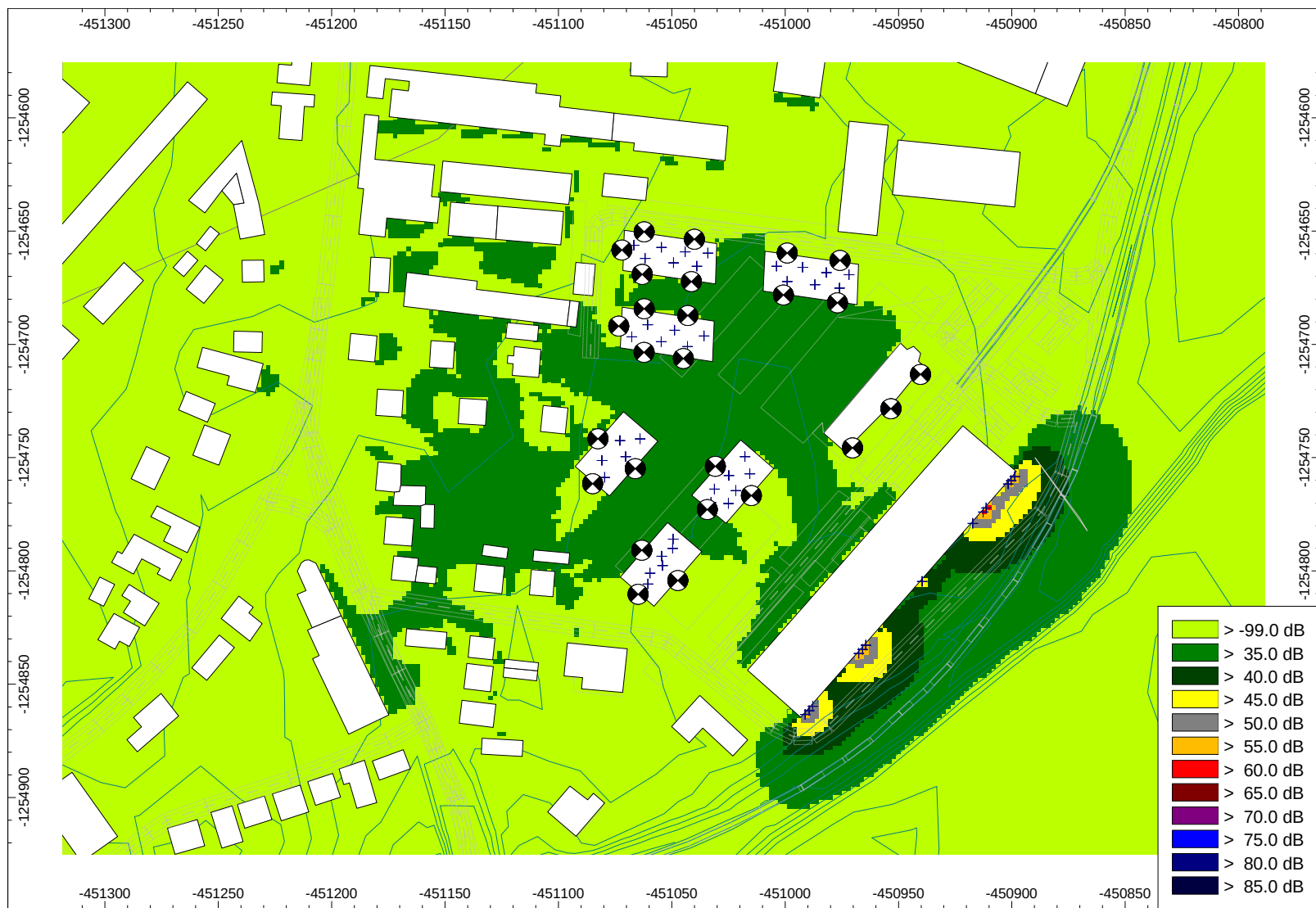
Variant 1 - Hluková mapa - hluk zo stacionárnych zdrojov obchodného centra a klimatizačných a chladiacich zariadení bytových jednotiek – referenčný časový interval NOC
