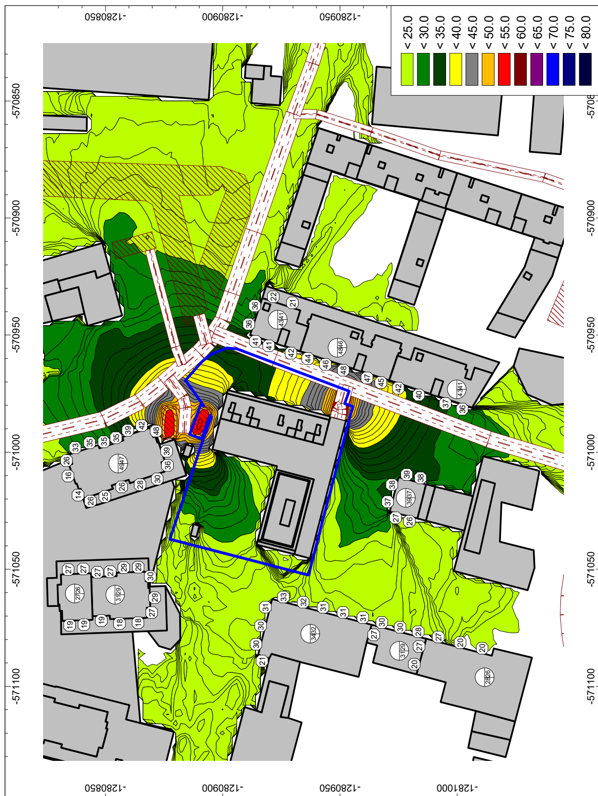
Obr. 36 plošná hluková záťaž vypočítaná vo výške 1,5 m nad terénom pre denný referenčný časový interval a hodnoty ekvivalentných hladín A zvuku pred fasádami najbližších chránených objektov, delenie pásiem po 5 dB
