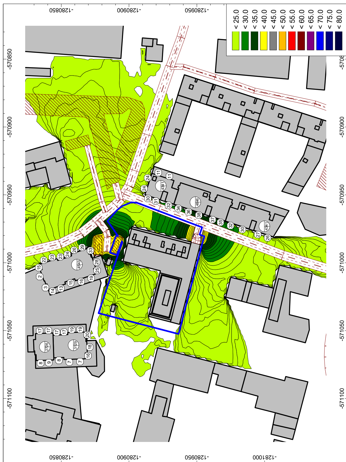
Obr. 38 plošná hluková záťaž vypočítaná vo výške 1,5 m nad terénom pre nočný referenčný časový interval a hodnoty ekvivalentných hladín A zvuku pred fasádami najbližších chránených objektov, delenie pásiem po 5 dB
