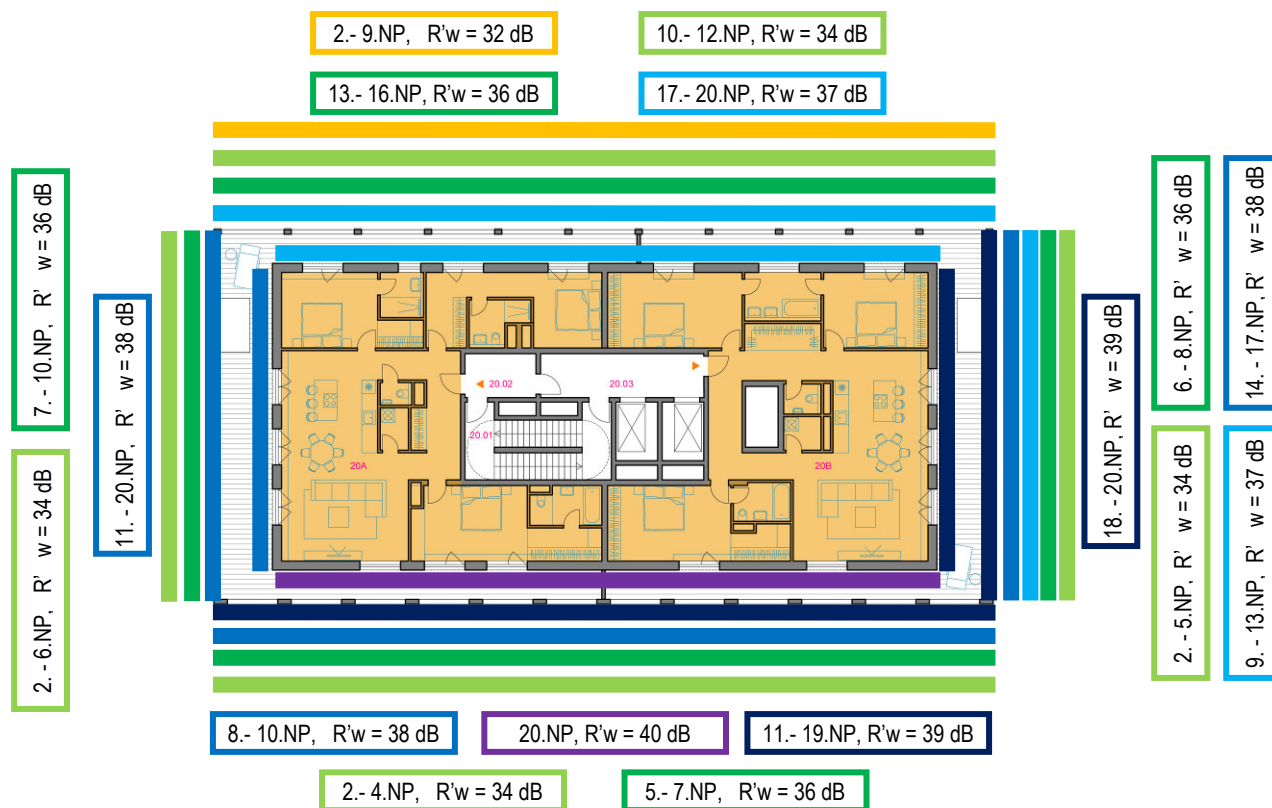
Obr. 42 požadované hodnoty nepriezvučnosti obvodových plášťov navrhovaného objektu A ( uvedené hodnoty nie sú požadovanými hodnotami zvukovej izolácie izolačných skiel ! )
