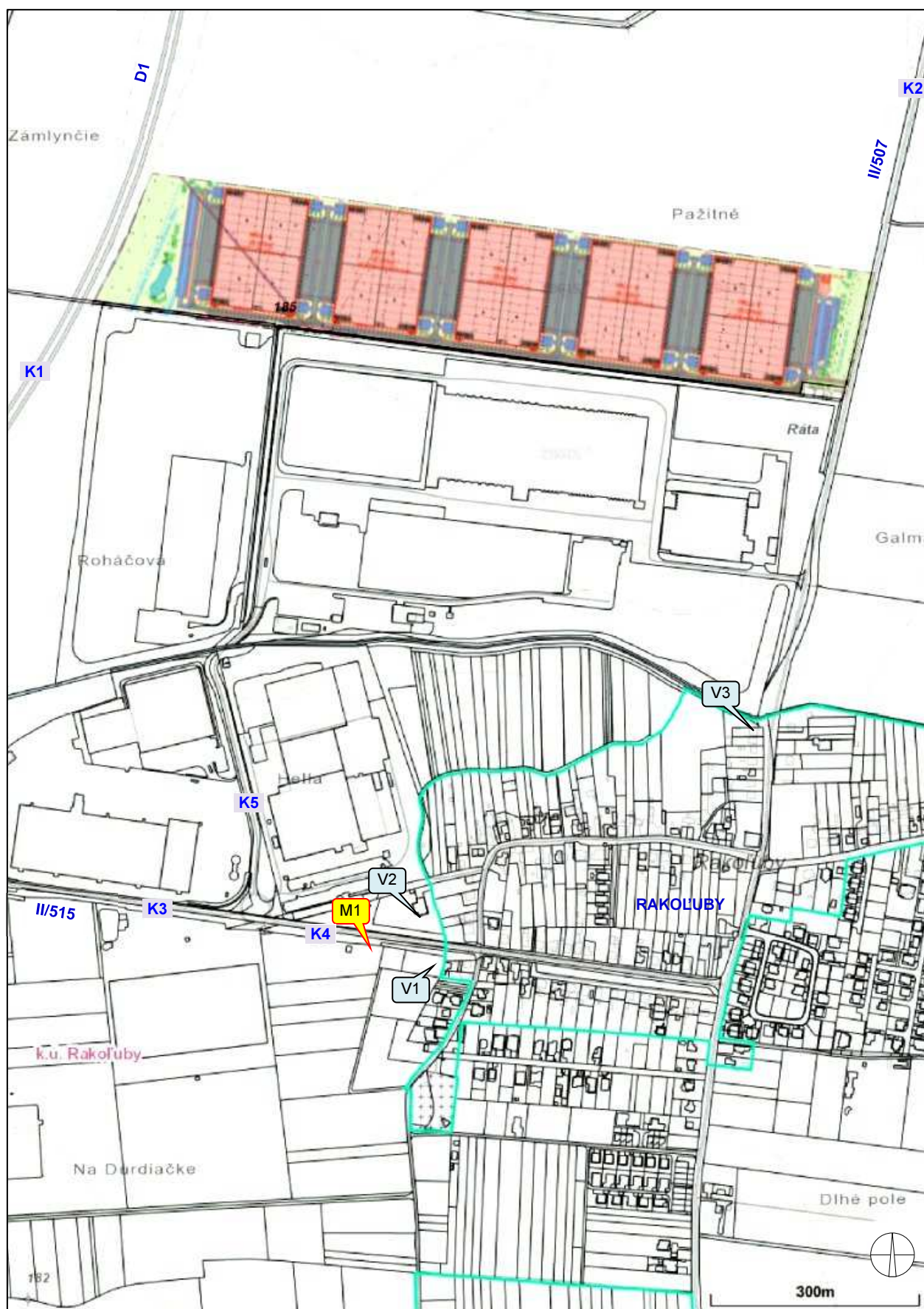
Obr. 1 situačná schéma zastavanosti územia M1 – miesto kalibračného merania hluku, V1..V3 – výpočtové body v území K1..K5 – líniové zdroje hluku,
