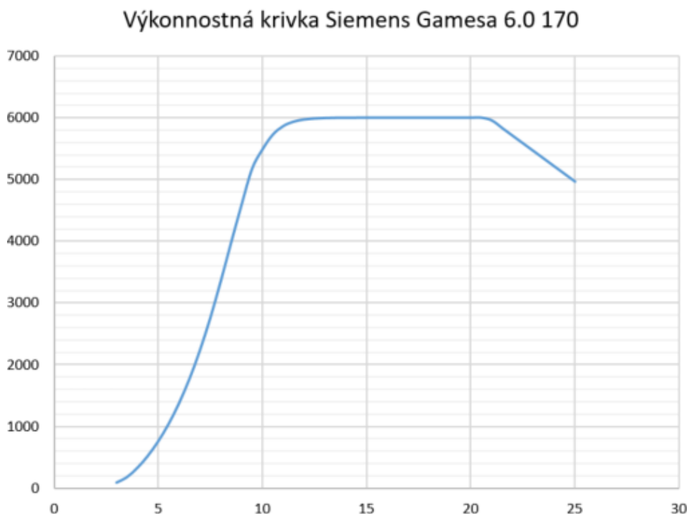
Obr. 11 Štandardný profil závislosti výkonu turbíny od rýchlosti vetra
