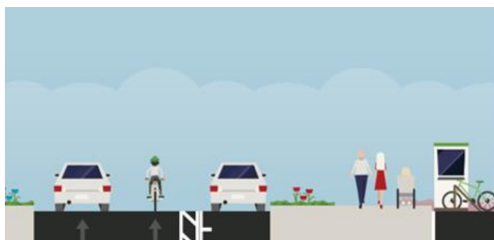
Obr. 5.4.9 B – segregácia vodorovným značením – cyklopruhy
