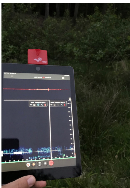
Obr. 4. Ultrazvukový detektor a Songmeter použitý na monitoring netopierov
