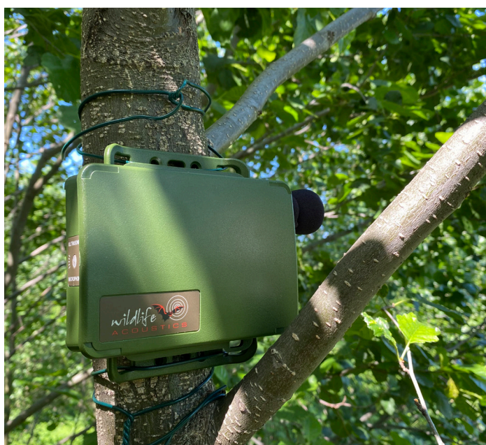
Obr. 4. Ultrazvukový detektor a Songmeter použitý na monitoring netopierov
