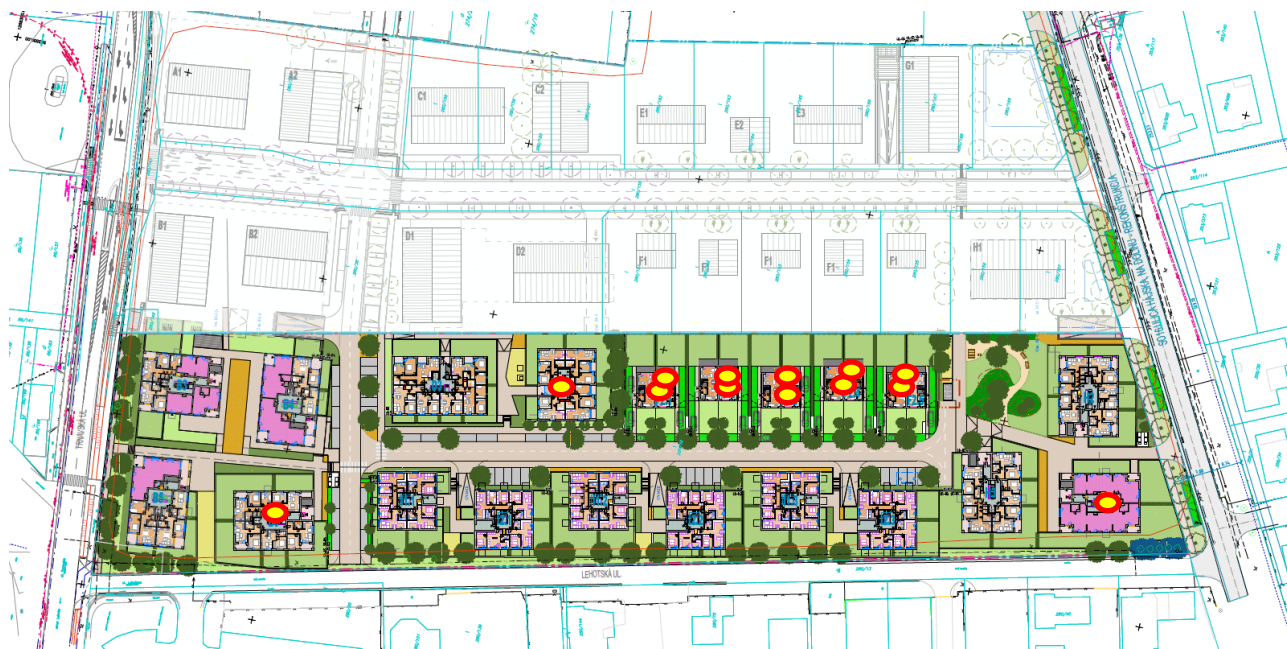
Obr. 12: Umiestnenie komínov vykurovania – variant 1
