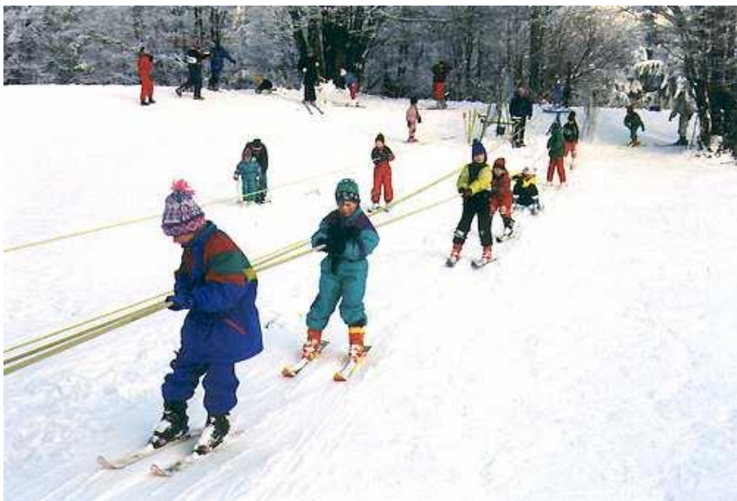
15 Navrhovaná zmena – prenosný detský lyžiarsky vlek s nízkym vedením lana typu LPVE 1,5 - 100 Zdroj: http://www.vleky.cz/
