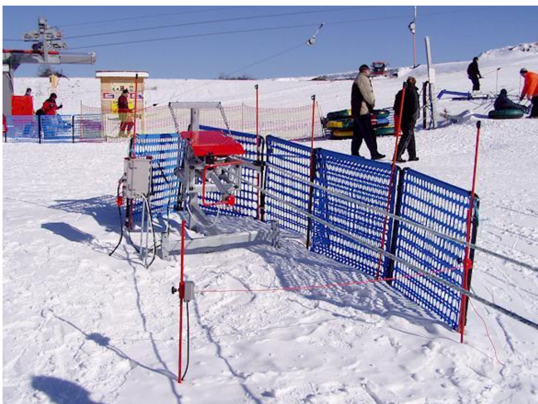
16 Navrhovaná zmena – prenosný detský lyžiarsky vlek s nízkym vedením lana typu LPVE 1,5 – 100, nástup Zdroj: http://www.vleky.cz/
