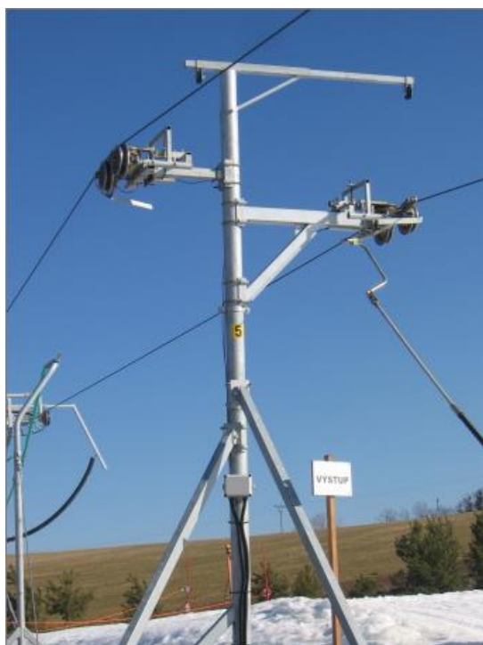
13, 14 Navrhovaná zmena - prenosný lyžiarsky vlek typu „Školní 300“, podpera, označenie výstupu Zdroj: http://www.vleky.cz/
