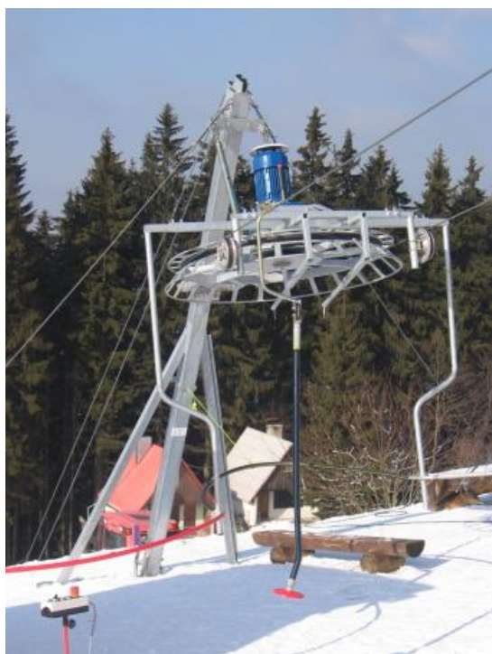
10, 11 Navrhovaná zmena - prenosný lyžiarsky vlek typu „Školní 300“, údolná (poháňacia, napínacia) stanica
