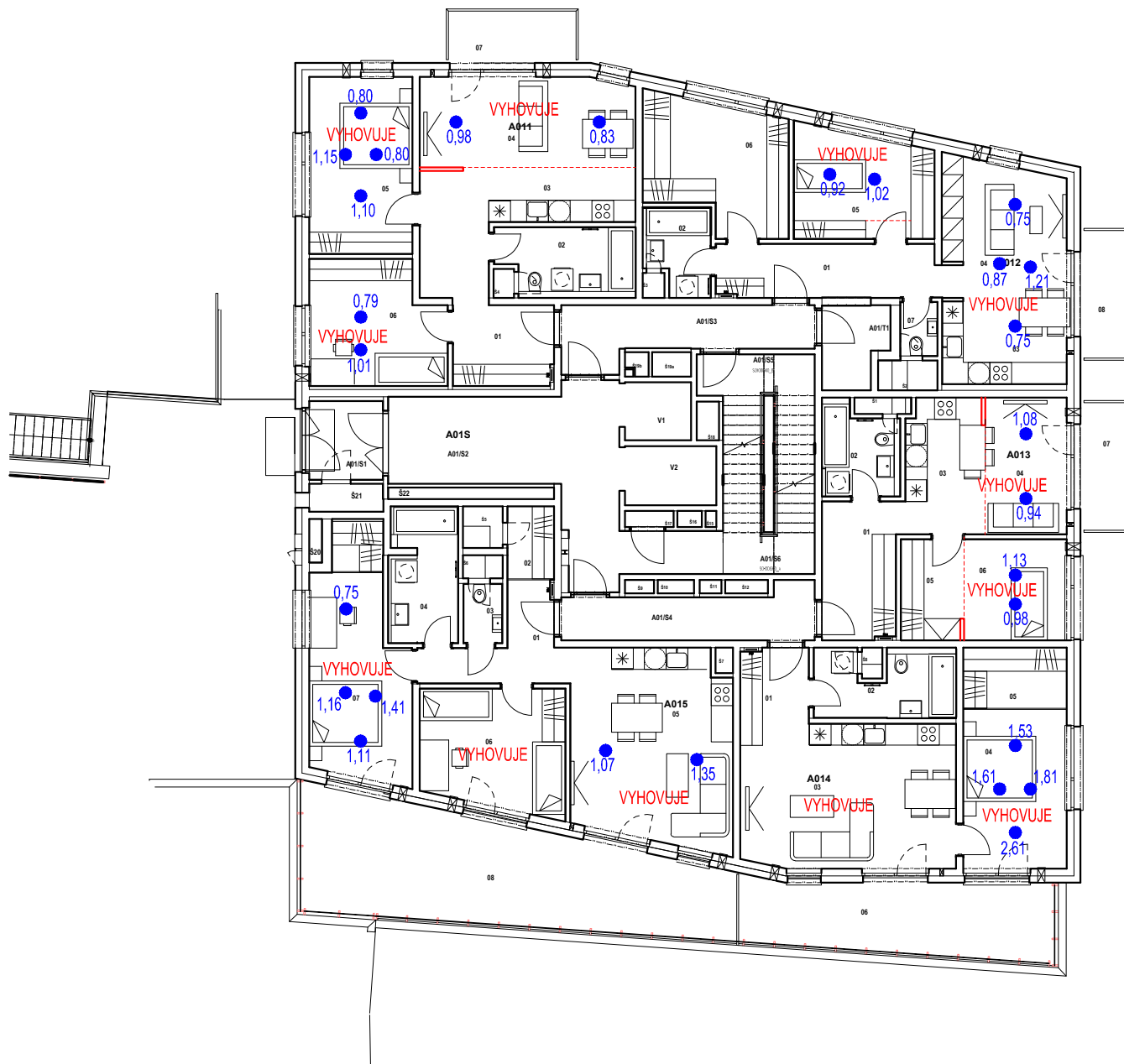
Obr. 14 Pôdorys 1.NP bytového domu a hodnoty č.d.o. na porovnávacej rovine obytných miestností
