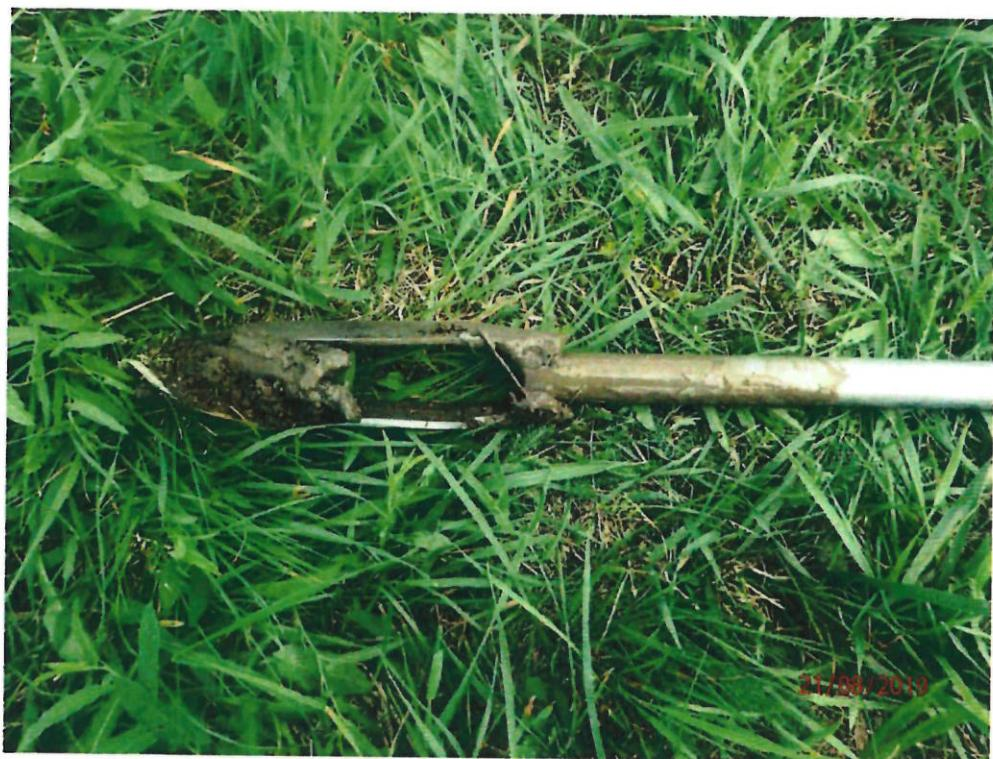
Obr. 4 Dôkaz prítomnosti hladiny podzemnej vody (HO-05)
