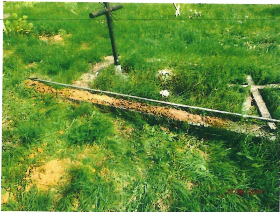
Obr. 3. Vývrt zeminy prieskumného vrtu (HO-01)
