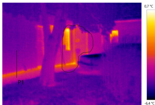
Termovízna snímka južnej časti budovy s vymedzenou oblasťou pre histogram a línie profilu P1, P2
