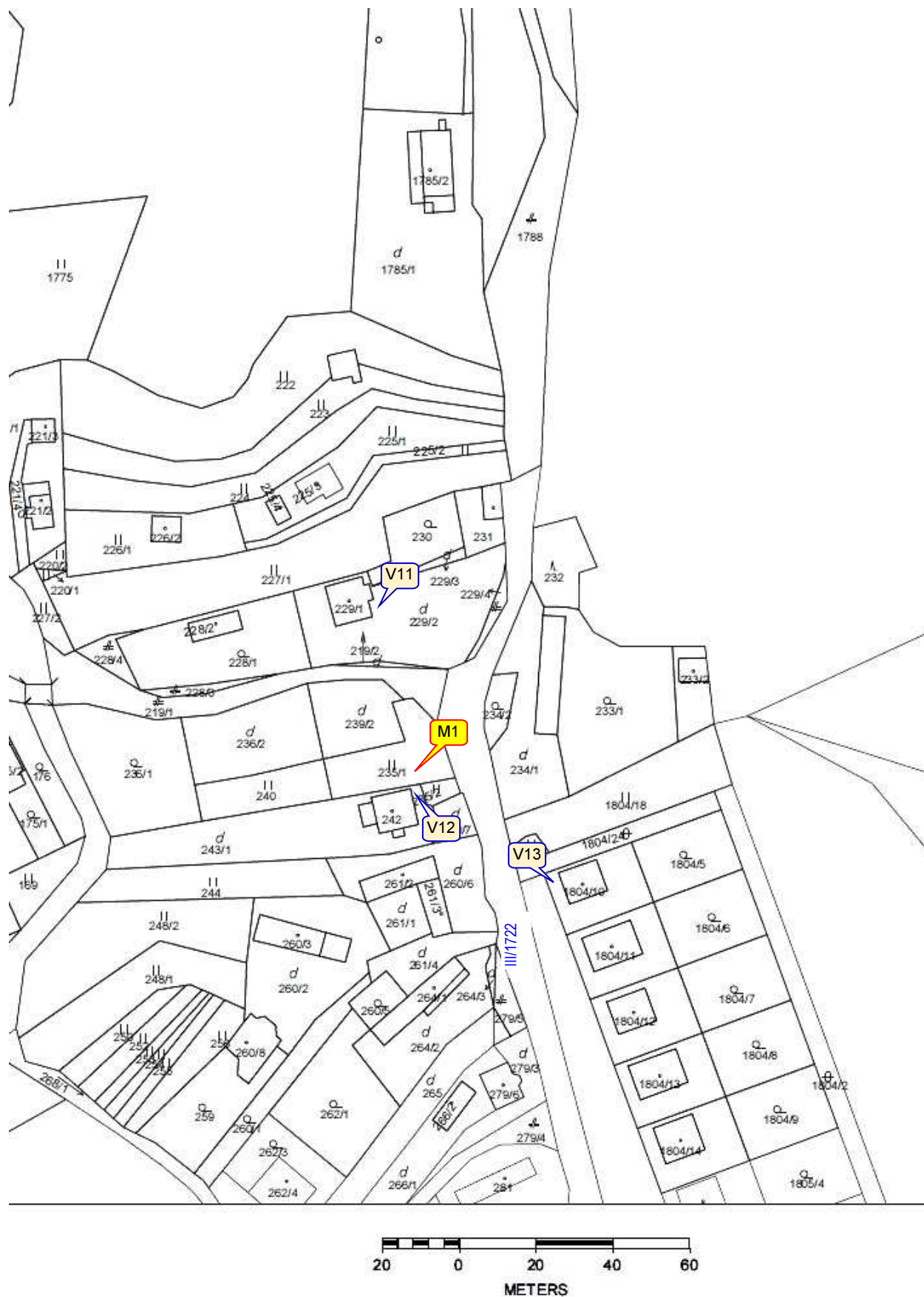
Obr. 2: Situačná schéma zastavanosti dotknutého obytného územia, M1 – miesto kalibračného merania hluku V11..V13 – výpočtové body v jestvujúcom chránenom prostredí
