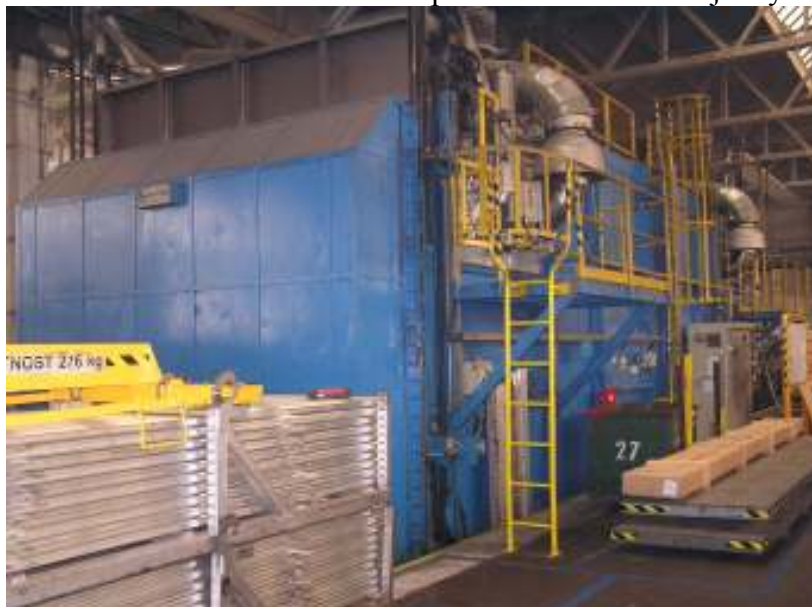
Obrázok č.7: Pec starnutia – bude premiestnená do novej haly lisovne
