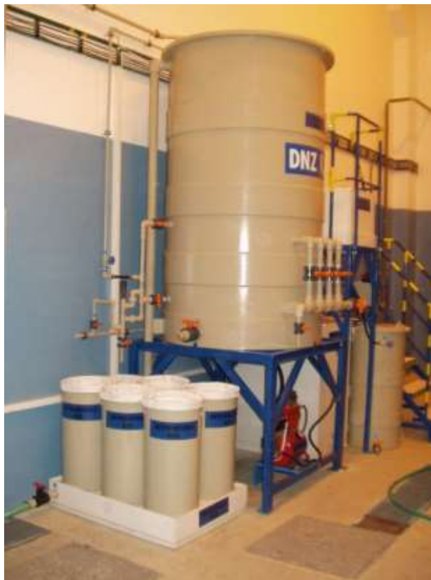
Obrázok č. 3: Deemulgačné a neutralizačné zariadenie DNZ1 s reaktorom 1 m 3 (ilustračný obrázok)
