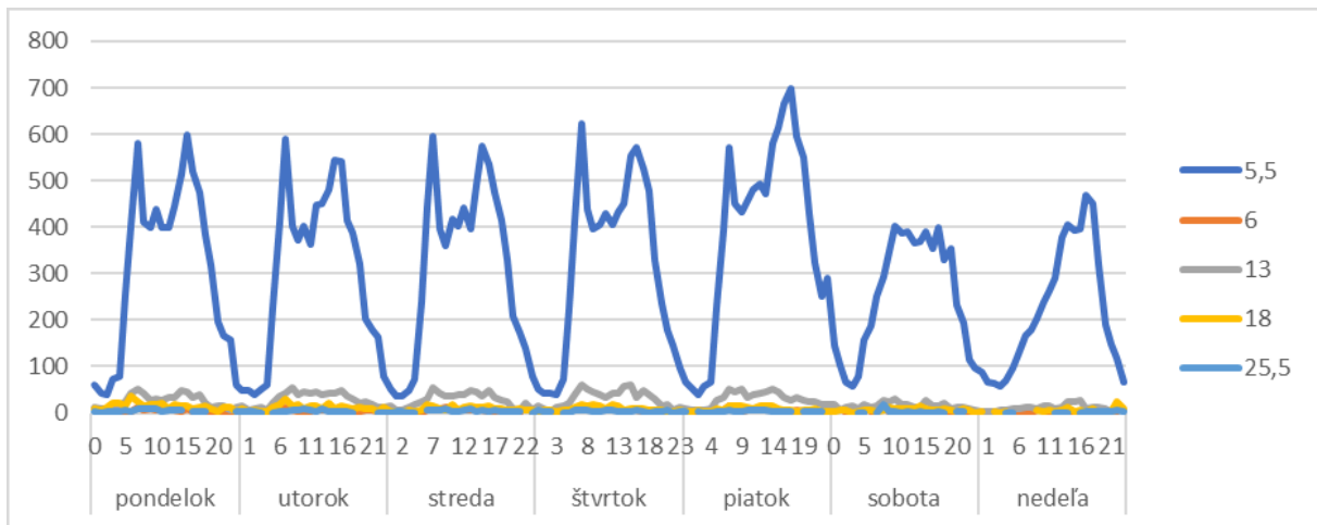
Graf 148 Týždenná variácia dopravy podľa dĺžkových kategórií vozidiel – 38. týždeň - voz./hod. na ceste I. triedy I/19 v obci Zalužice
