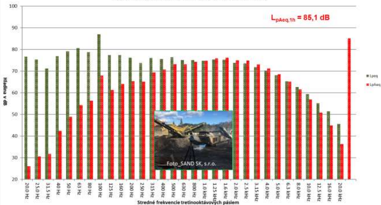
Obr. 2.12 Informatívna tretínoktávová frekvenčná analýza zvuku pri pracovnej činnosti Odrazového drviča RM 100GO a Triediaceho zariadenia Keestrack K3 zo dňa 06.11.2019 s umiestnením mikrofónu v meracom bode M3_2 - vo výške 1,5 m a vo vzdialenosti 9 m, v areály firmy SAND SK, s.r.o. Zdroj hluku: chod odrazového drviča a triediaceho zariadenia - drvenie andhezitu.
