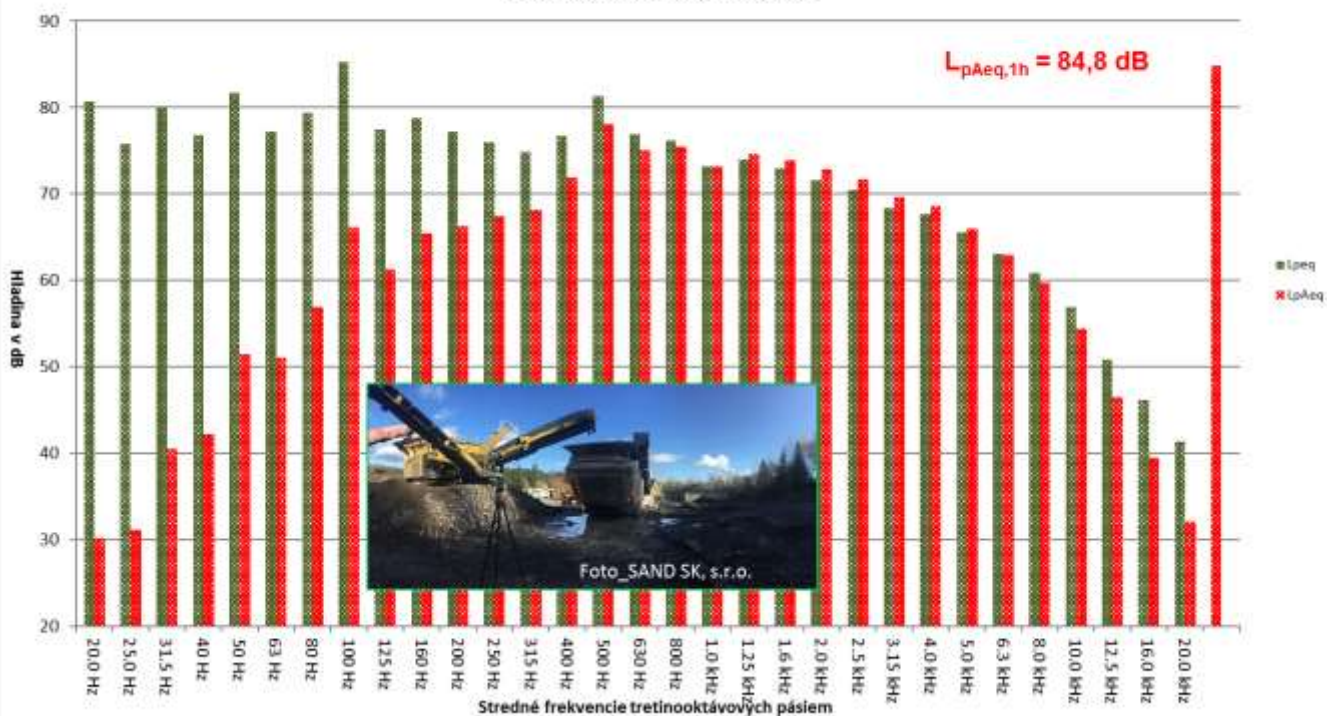
Obr. 2.10 Informatívna tretinooktávová frekvenčná analýza zvuku pri pracovnej činnosti Odrazového drviča RM 100GO a Triediaceho zariadenia Keestrack K3 zo dňa 06.11.2019 s umiestnením mikrofónu v meracom bode M3_1 - vo výške 1,5m a vo vzdialenosti 3 m, v areály firmy SAND SK, s.r.o. Zdroj hluku: chod drvičky a triediaceho zariadenia - voľnobeh.
