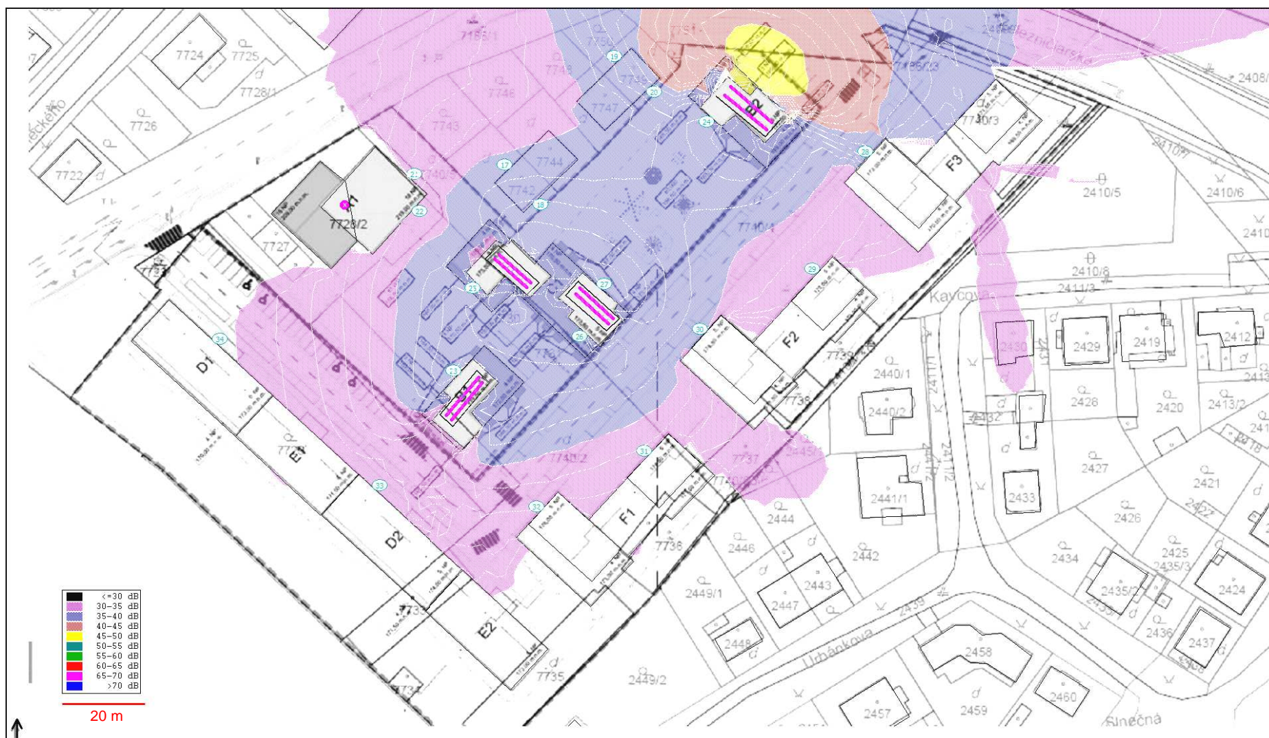
Obr. 9 Hluková mapa ekvivalentných hladín hluku z prevádzky VZT na strechách stavebných objektov s protihlukovými úpravami , výška izofon 15 m
