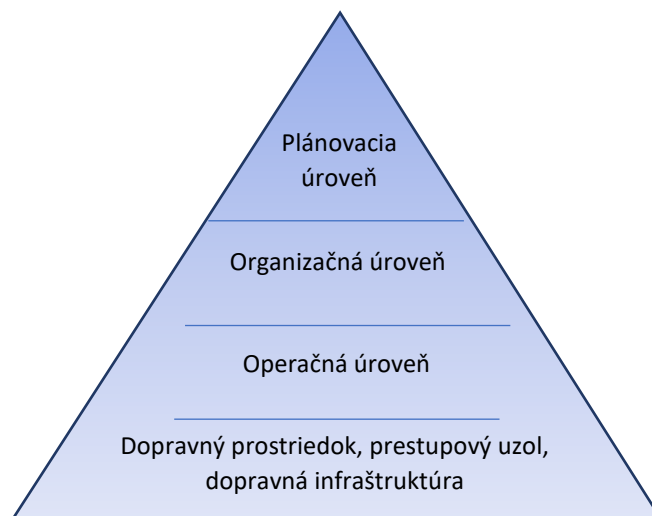
Obrázok 19 Controlling VD – základná architektúra telematiky vo verejnej doprave
