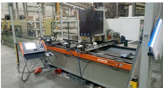
Obr. 11 Elumatec SLK 118 – frézovanie oceleovej výstuhy
