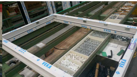
Obr. 13 Osadenie bezpečnostného kovania na krídla okna
