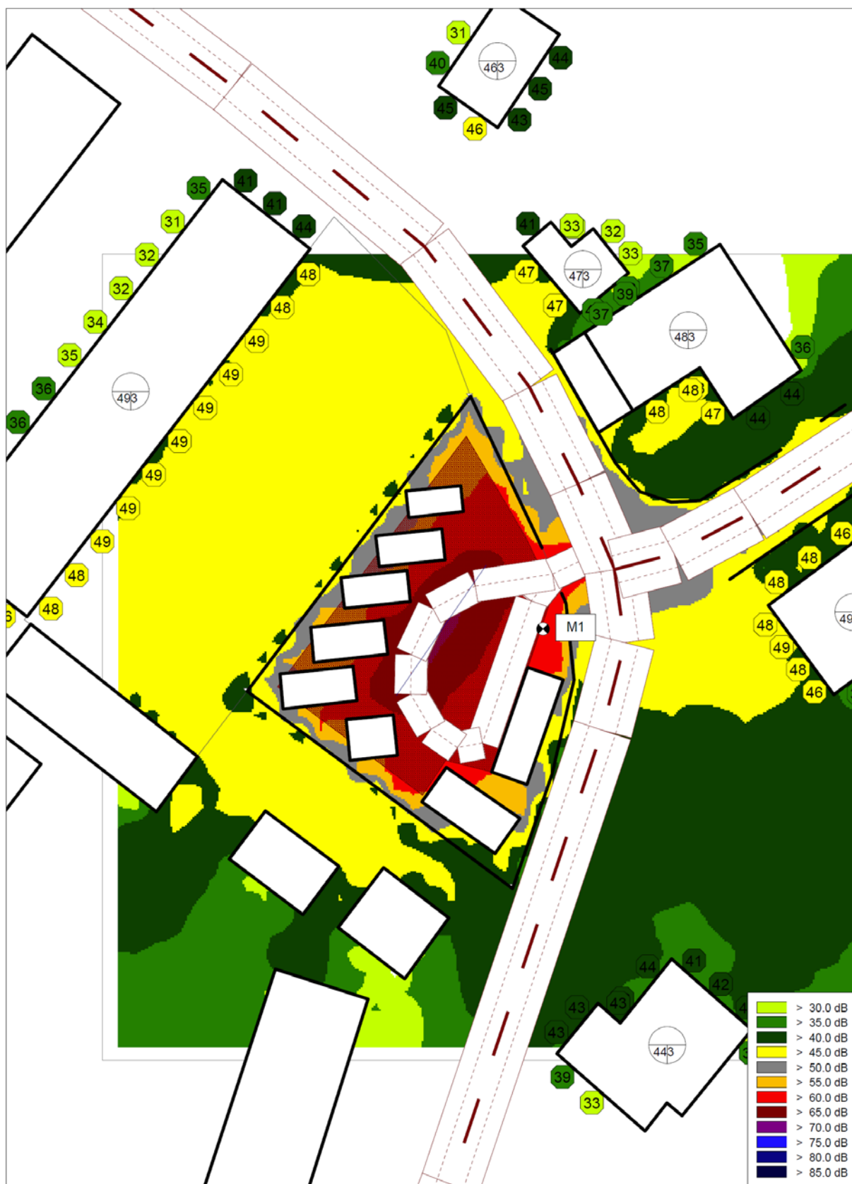
Priebeh hladín A zvuku pre výšku 1,5m nad terénom, delenie po 5dB „po výstavbe objektu – variant V1“, deň (6:00 – 18:00), vrátane neistoty merania +2,3
