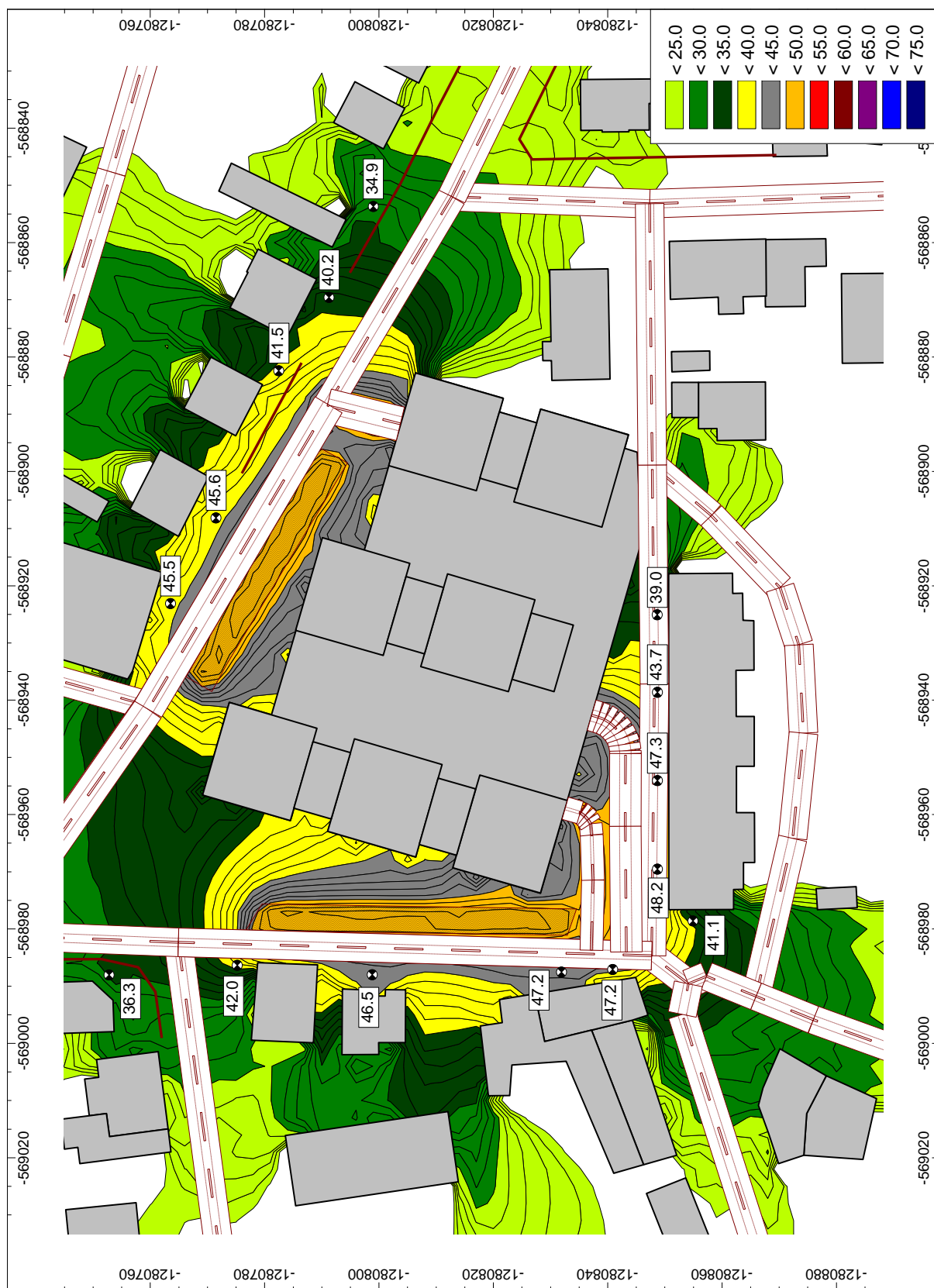
Obr. 25 plošná hluková záťaž vypočítaná vo výške 1,5 m nad terénom pre denný referenčný čas a hodnoty ekvivalentných hladín A zvuku pred fasádami najbližších chránených objektov (rodinné domy a bytový dom) vo výške 1,5 m nad terénom
