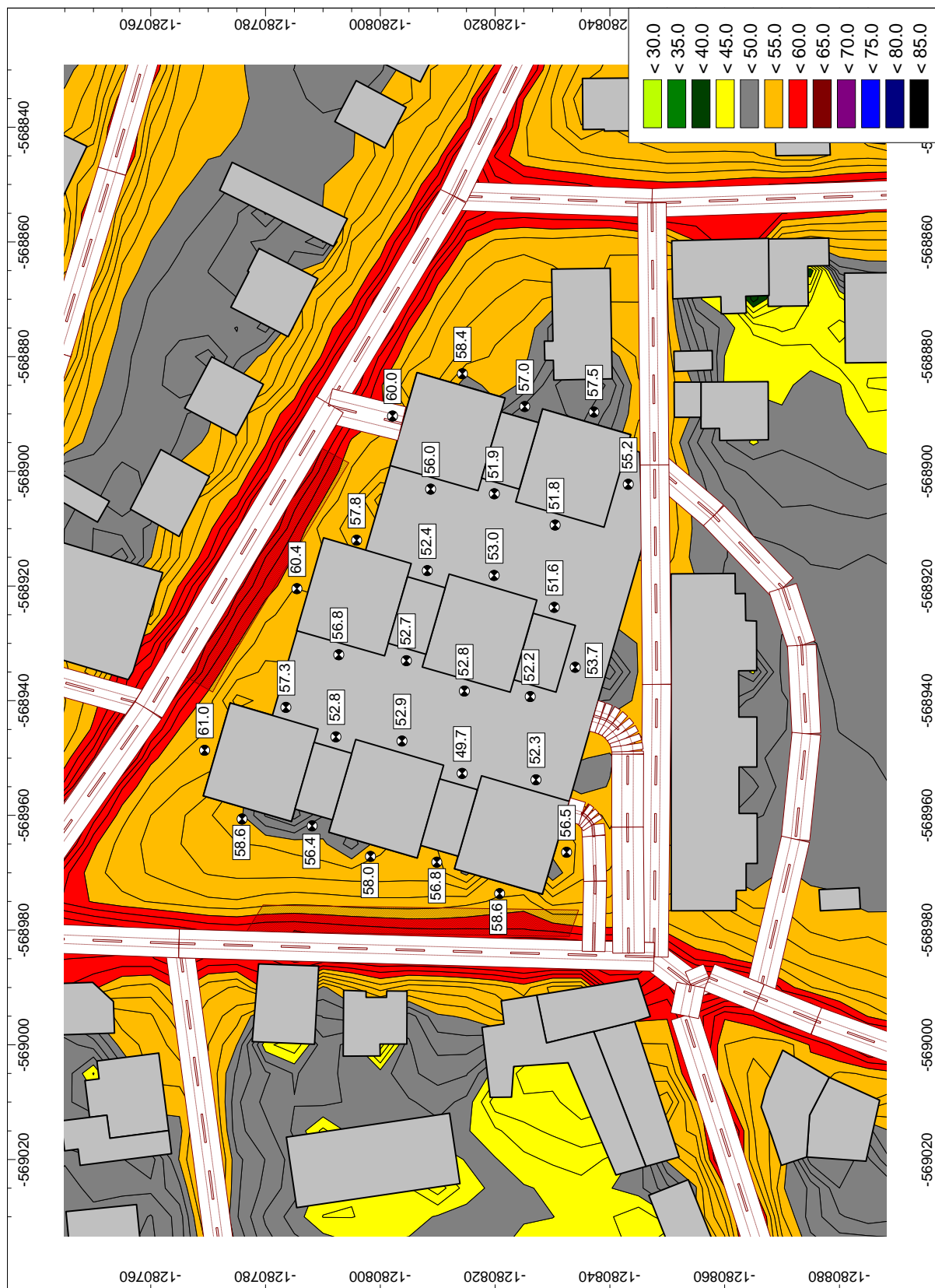
Obr. 28 plošná hluková zátťaž vypočítaná vo výške 1,5 m nad terénom pre denný referenčný čas a hodnoty ekvivalentných hladín a zvuku z dopravy vypočítané vo výške 4. NP
