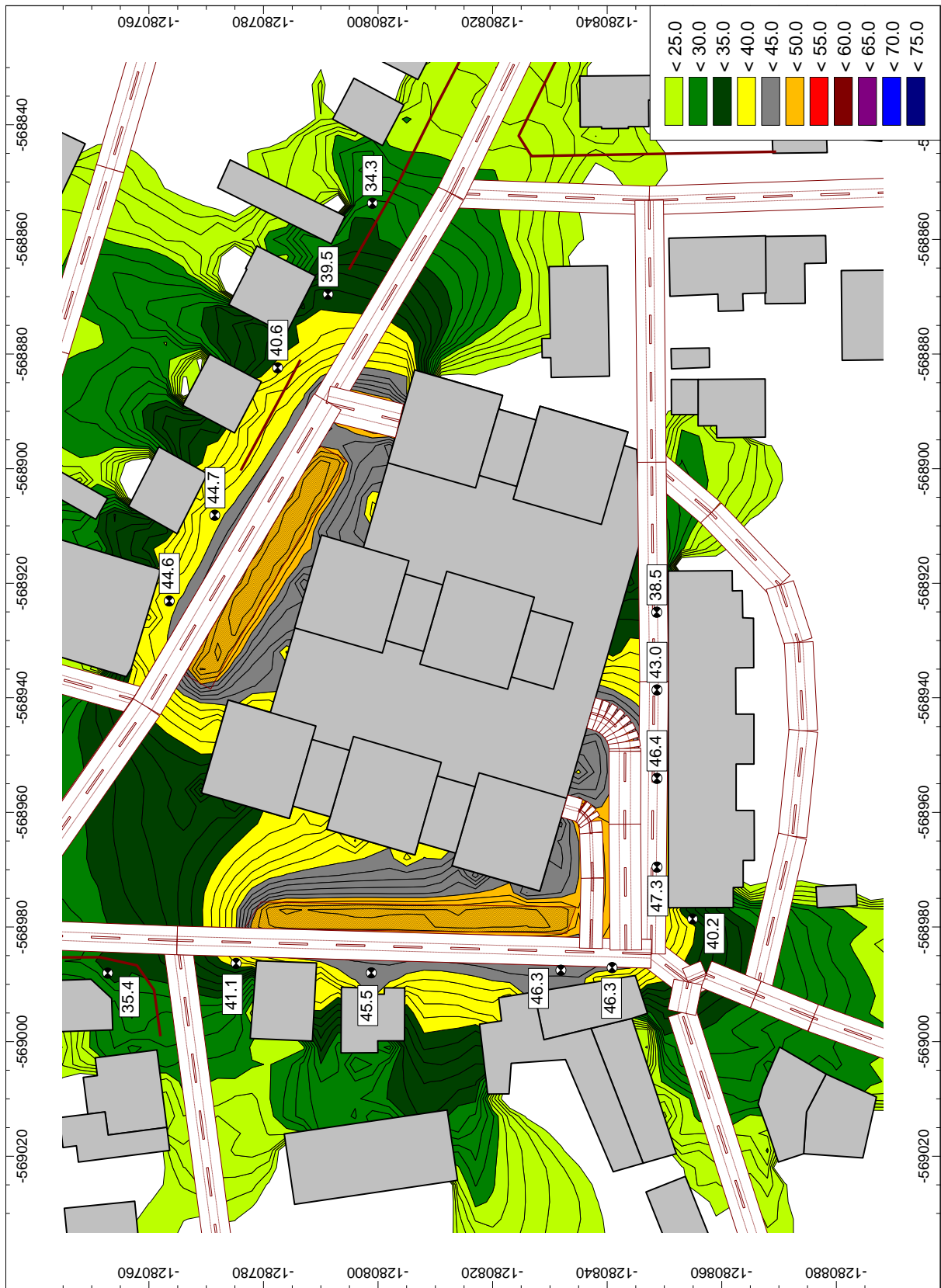
Obr. 26 plošná hluková záťaž vypočítaná vo výške 1,5 m nad terénom pre večerný referenčný čas a hodnoty ekvivalentných hladín A zvuku pred fasádami najbližších chránených objektov (rodinné domy a bytový dom) vo výške 1,5 m nad terénom
