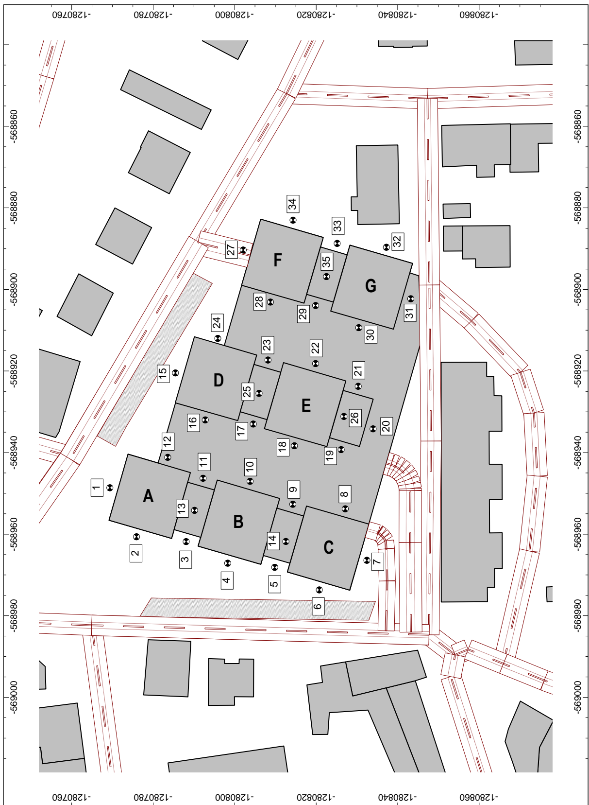
Obr. 31 rozmiestnenie imisných bodov pred fasádami navrhovaných objektov
