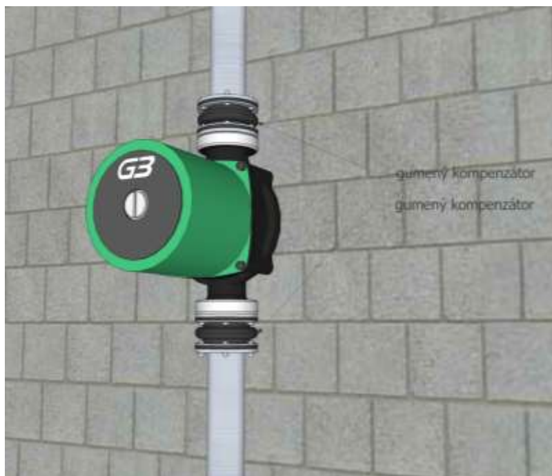
Obr. 8: Použitie gumených kompenzátorov pre pripojenie obehového čerpadla
