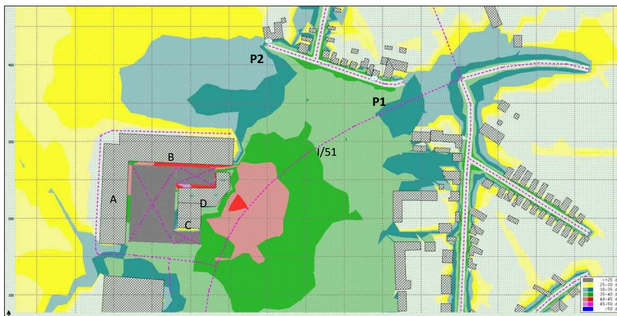
Obr. 3 Vypočítané hlukové pásma L_{Aeq} vo výške 2,0 m nad terénom, delenie pásiem po 5 dB – hluk z iných zdrojov – iba z novonavrhovanej objektu D, nočný čas
