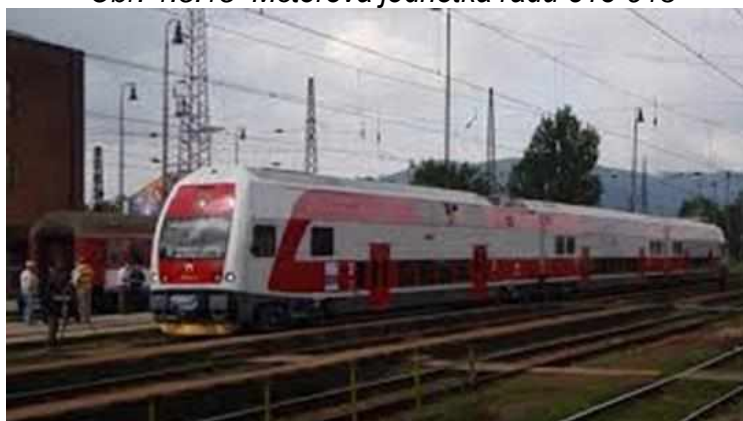
Obr. 1.5.16 Elektrická poschodová jednotka radu 671
