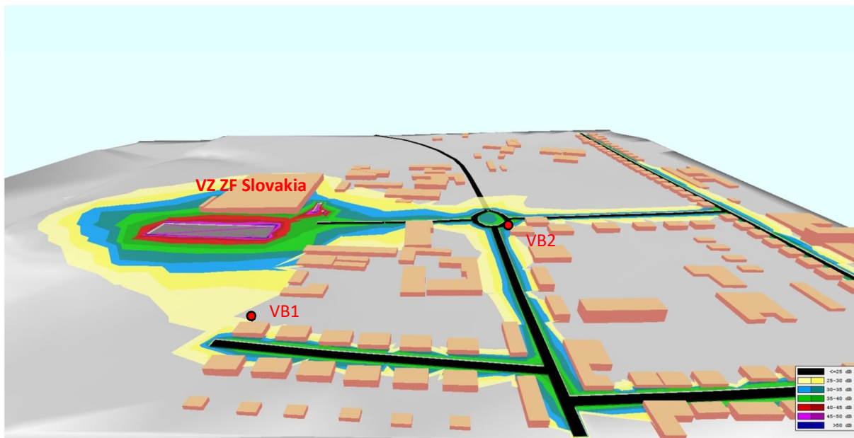
Obr. 4 Vypočítané hlukové pásma L_{Aeq} vo výške 2,0 m nad terénom, delenie pásiem po 5 dB – hluk z iných zdrojov – 3D model
