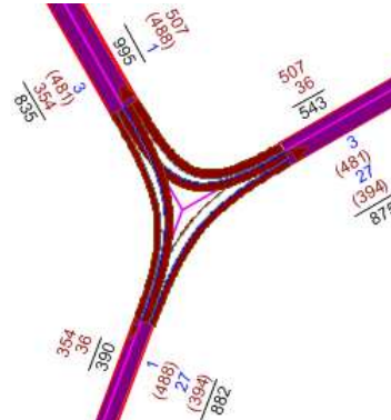
Tabuľka 81 – Parametre kapacity neriadenej križovatky – ŠHID AM 2027ZP-172
