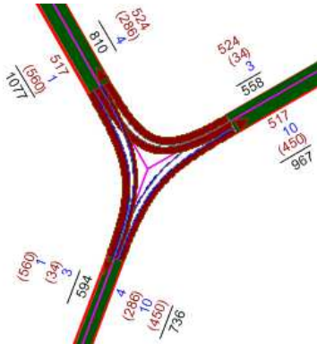
Tabuľka 83 – Parametre kapacity neriadenej križovatky – ŠHID AM 2027ZP-172
