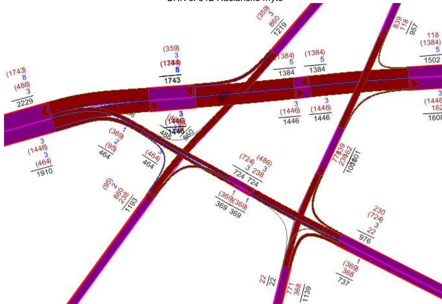
Taбуlka 50 – Parametre kapacity svetelne riadenej križovatky – ŠHID PM 2017PP-127 SRK č. 612 Račianske mýto
