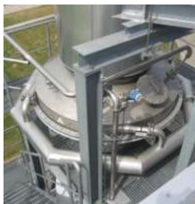
Obr. č.7 a č.8 - Čistenie plynov pri technologickom zariadení na splyňovanie odpadov firmy EKO HYBRES Sp. z o. o. Rzeszów v Rogoźnici. - zariadenie vyrába nemecká spoločnosť TREMA - referencie na webovom sídle www.trema.de
