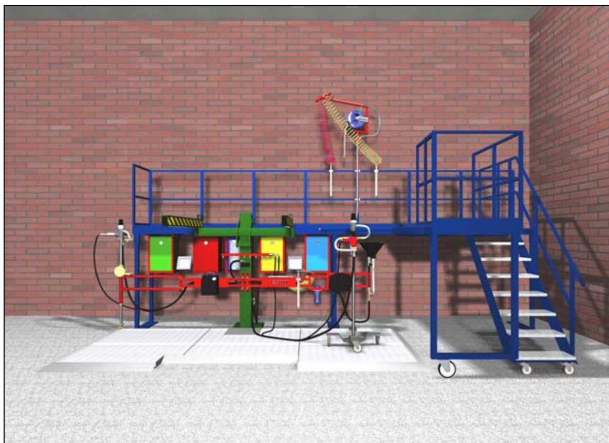
Obrázok 6. Vysúšacia linka SEDA – základná zostava pre vysušanie jedného vozidla
