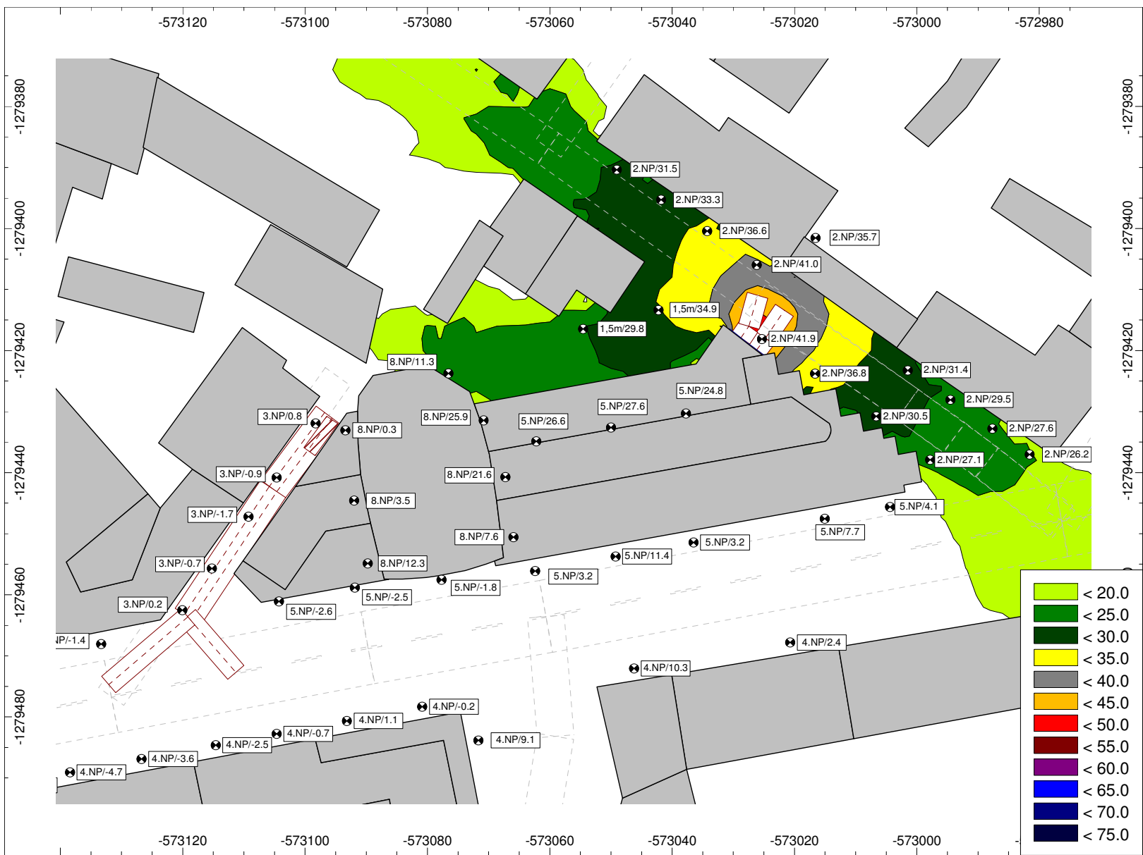
Obz. 32 plošná hluková zátáž vypočítaná vo výške 1,5 m nad terénom pre nočný referenčný čas a hodnoty ekvivalentných hladín A zvuku z prevádzky stacionárneho zdroja a vjazdu do navrhovaného objektu pred fasádami vlastného objektu a najbližších existujúcich bytových domov
