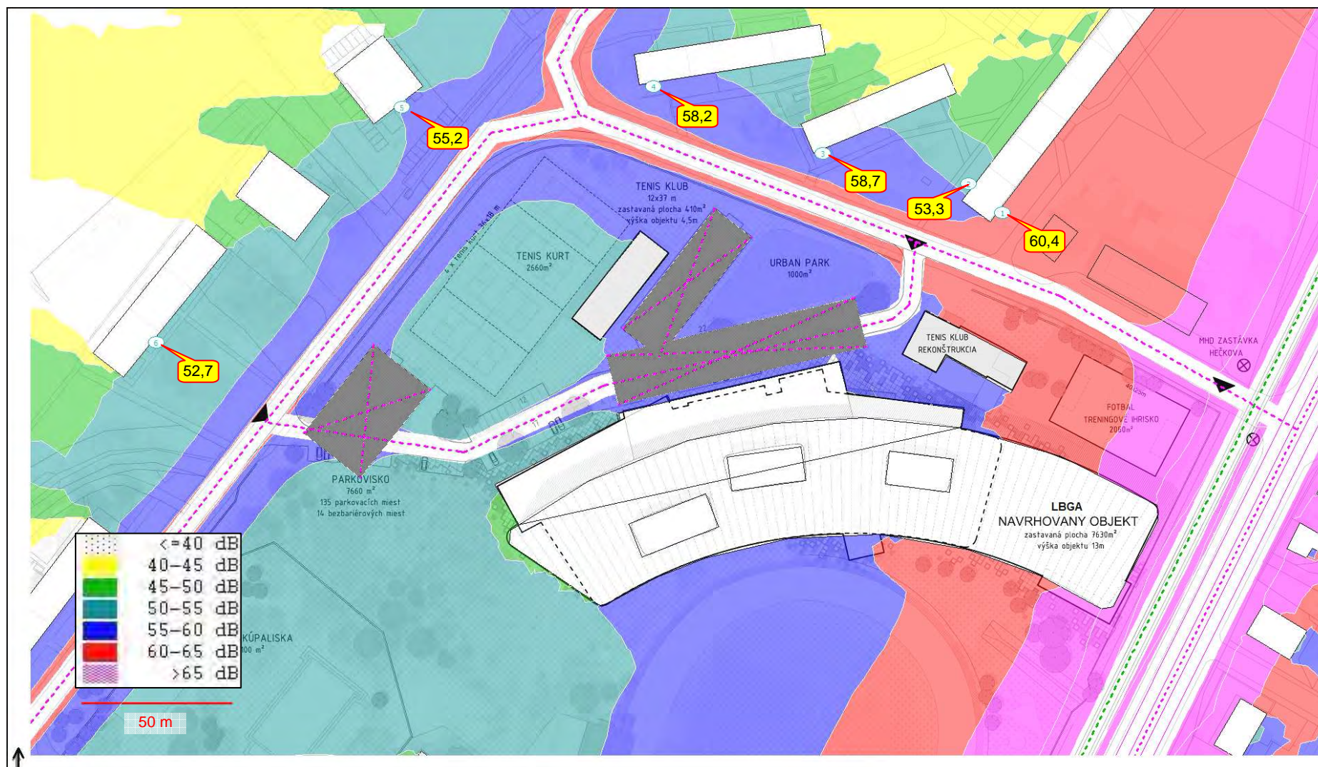
Obr. 5 Mapa hladín hluku z dopravy v riešenom území cez deň a večer L_{Aeq,16h} po realizácii projektu vo variante V2, výška izofon 5 m
