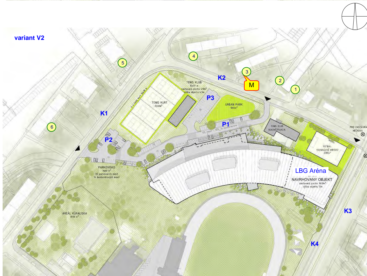
Obr. 1 Situačné schéma zastavanosti záujmového územia vo variante V1 a V2, M – miesto merania hluku 1..6 – výpočtové body, K1..K4, P1..P3 – líniové a plošné zdroje hluku
